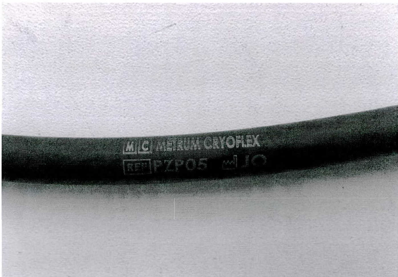
Шланг для подключения аппарата к баллону, длина 0,5 м – пример маркировки на шланге
