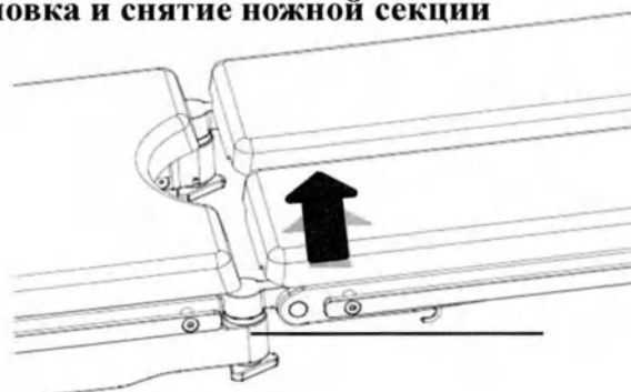
Рисунок 16: Установка и снятие ножной секции
