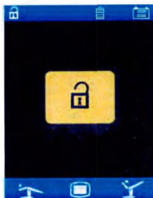
Рисунок 39: Регулировка наклона операционного стола в продольном направлении (блокировка снята)
