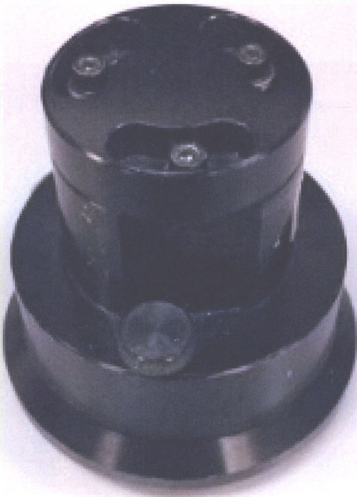
32.1 Тестовый глаз для оптической когерентной томографии в спектральной области, юстировка пользователя
