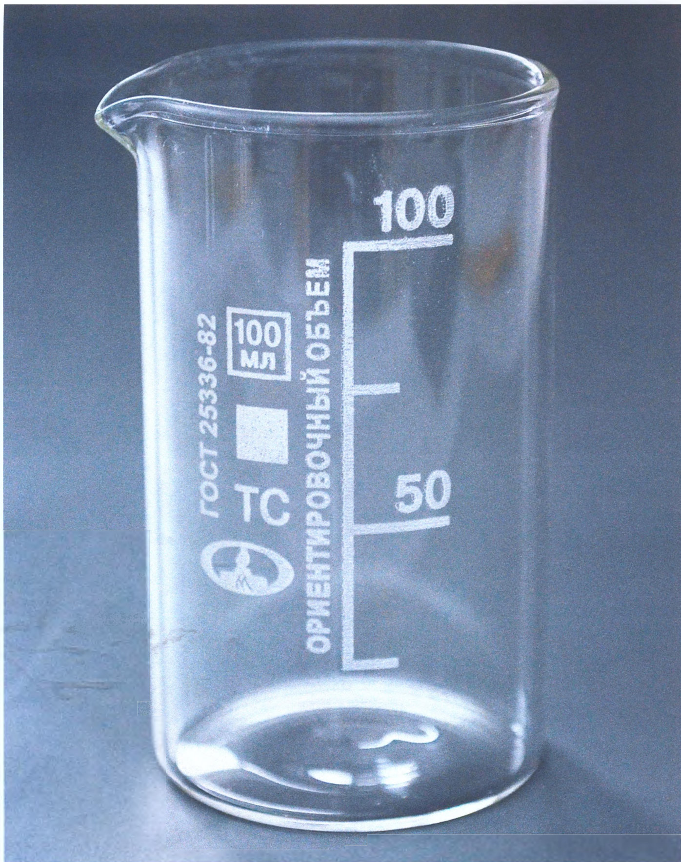
Стакан типа В (высокий) исполнения 1 (с носиком) номинальной вместимостью 100 мл
