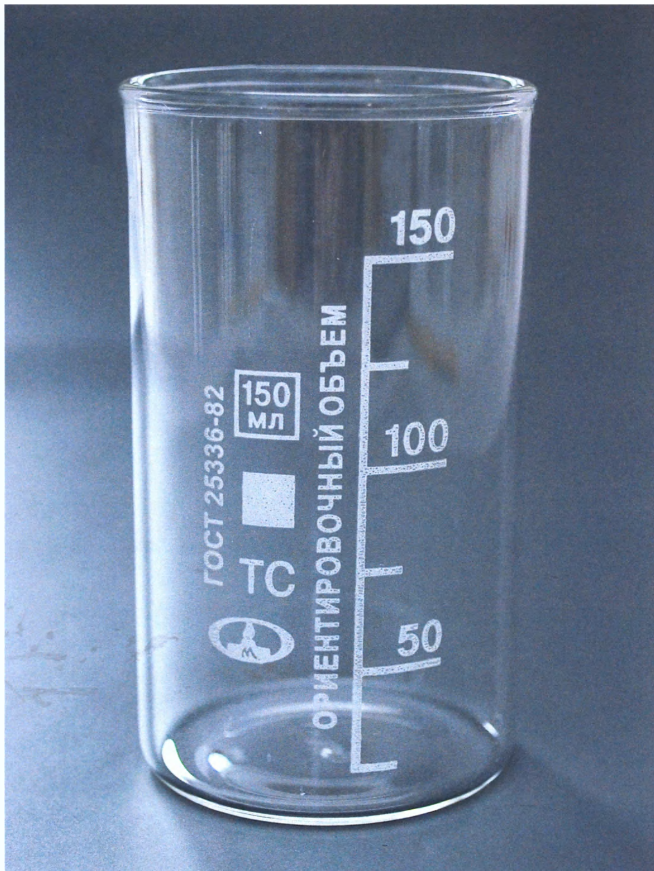
Стакан типа В (высокий) исполнения 2 (без носика) номинальной вместимостью 150 мл
