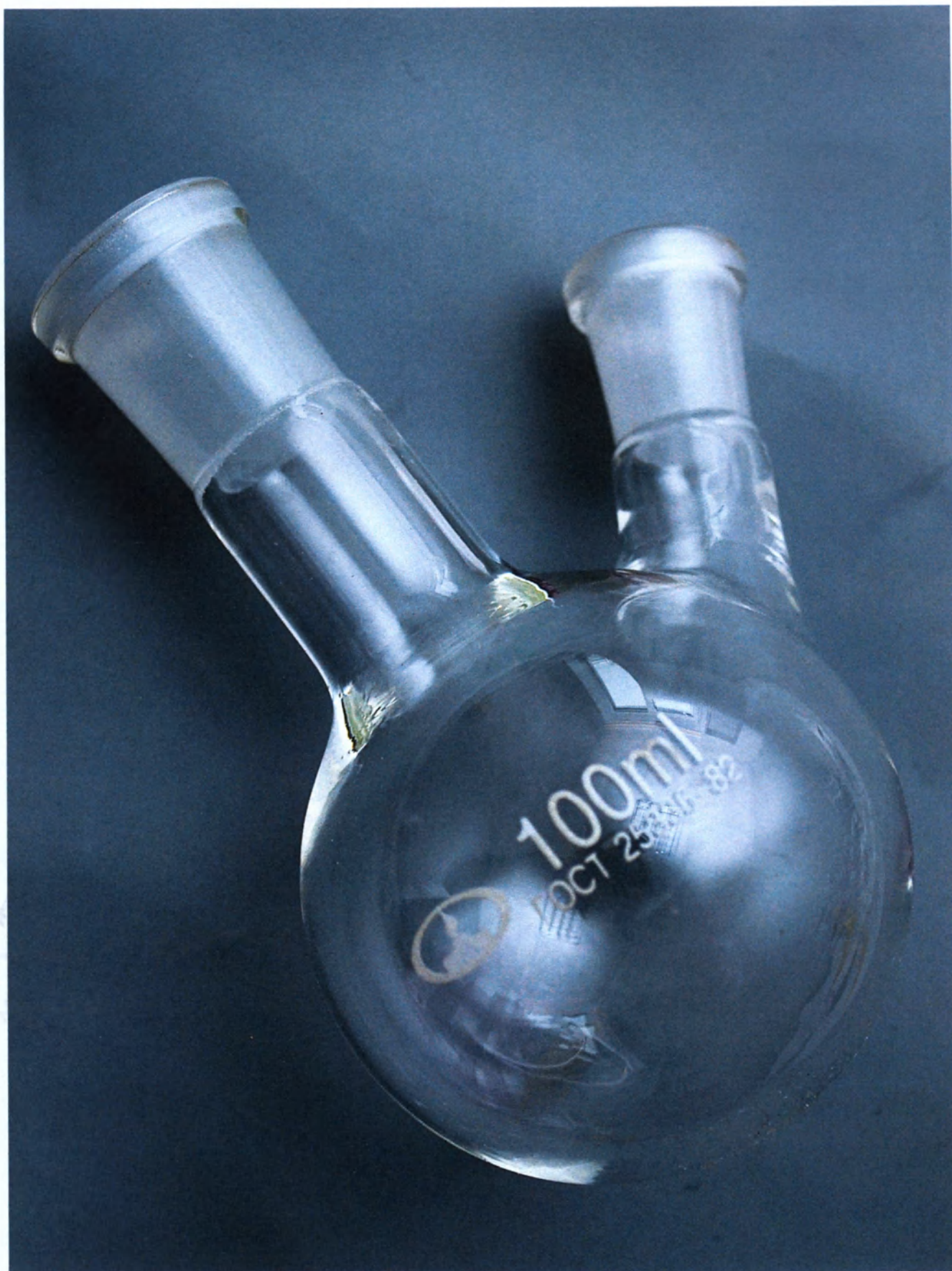
Колба круглодонная с двумя горловинами типа КГУ-2 исполнения 1, номинальной вместимостью 100 мл с взаимозаменяемым конусом, конус центральной горловины 19/26, конус боковой горловины 14/23
