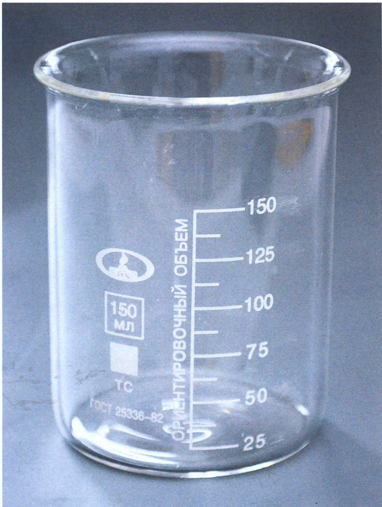
Стакан типа Н (низкий) исполнения 2 (без носика) номинальной вместимостью 150 мл
