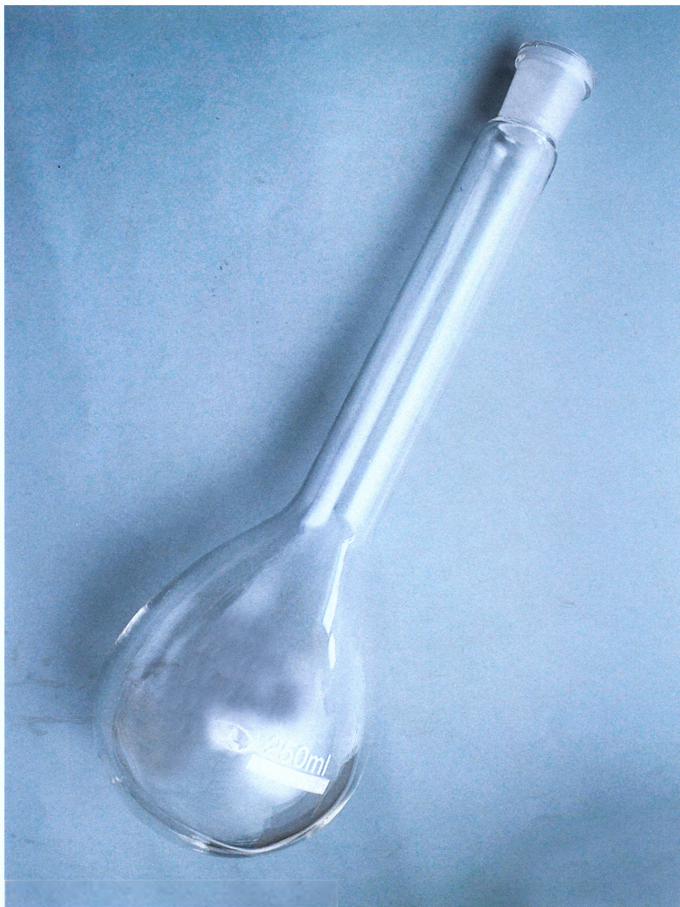
Колба Къельдаля исполнения 1, номинальной вместимостью 250 мл с взаимo-заменяемым конусом 19/26
