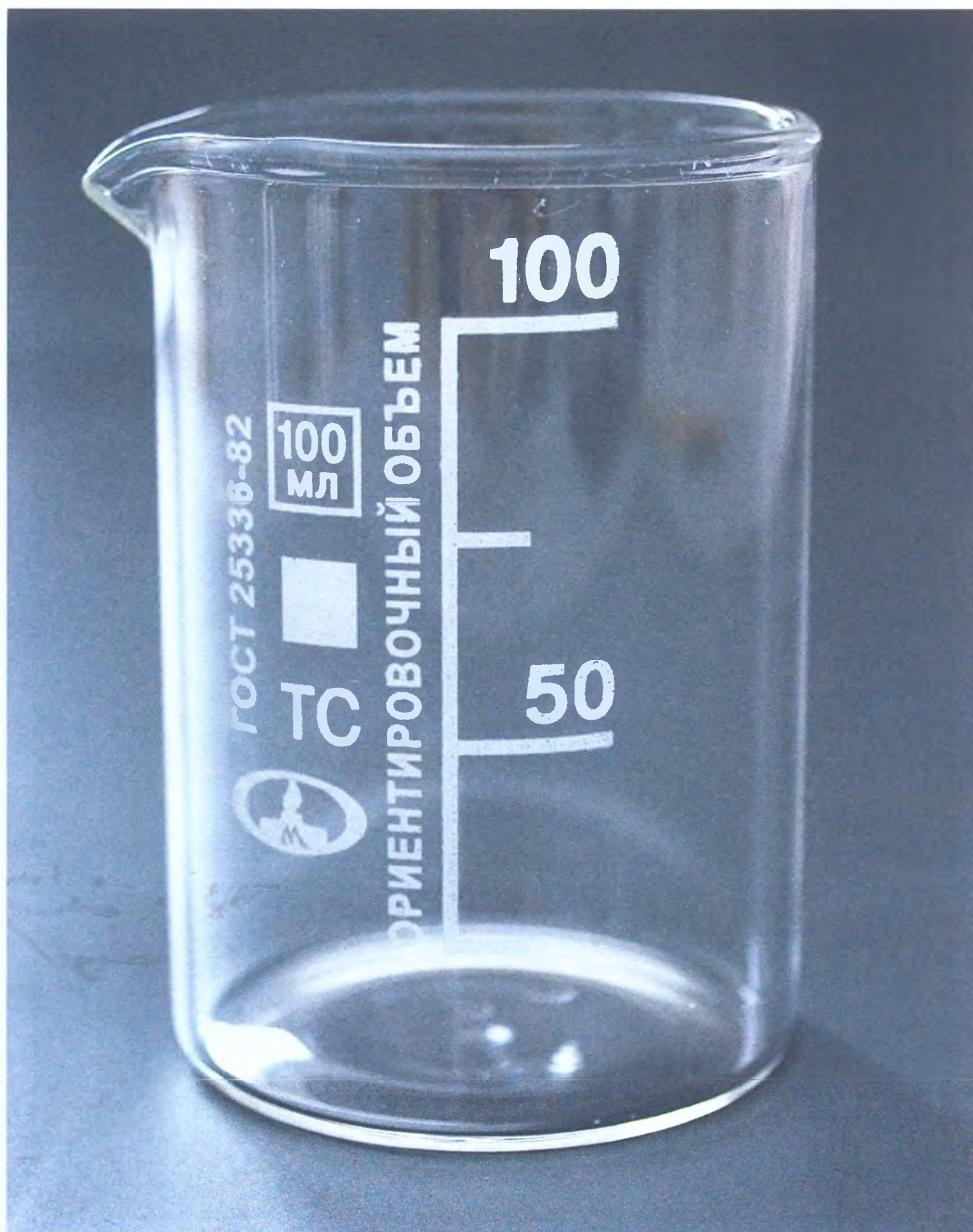
Стакан типа Н (низкий) исполнения 1 (с носиком) номинальной вместимостью 100 мл
