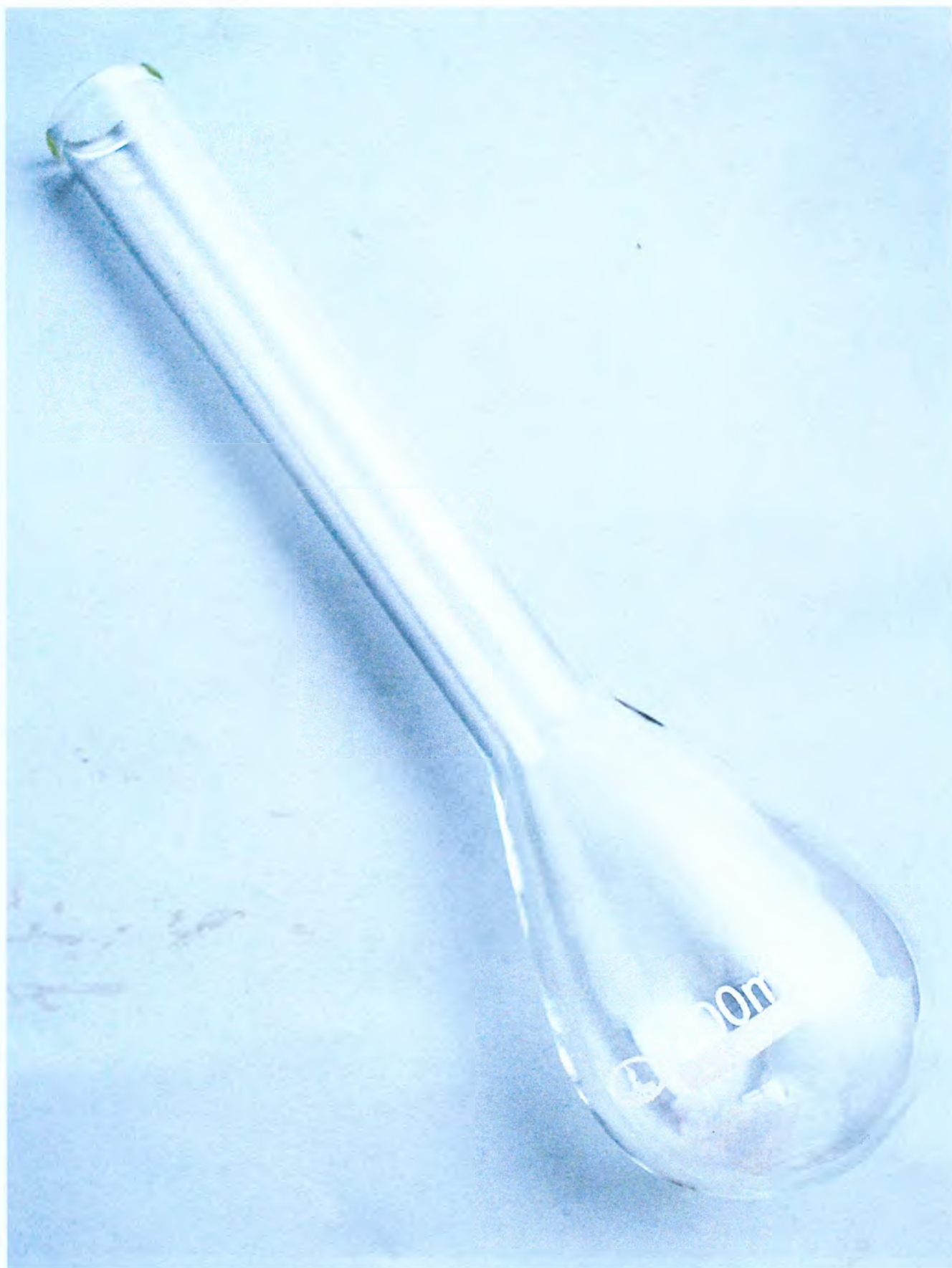
Колба Къельдаля исполнения 2, номинальной вместимостью 100 мл с диаметром горловины 22 мм
