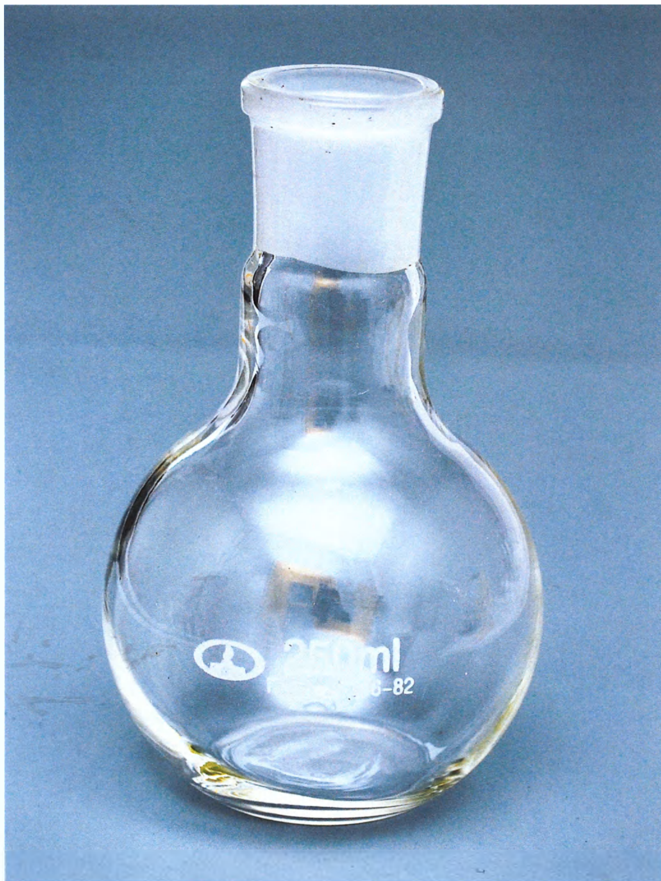
Колба плоскодонная типа П исполнения 1, номинальной вместимостью 250 мл с взаимозаменяемым конусом 29/32
