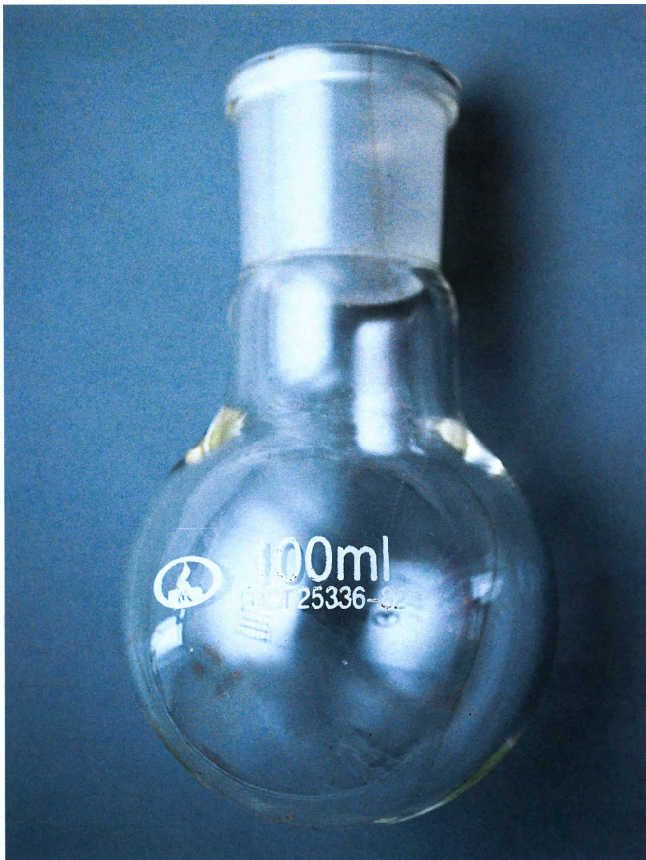
Колба круглодонная типа К исполнения 1, номинальной вместимостью 100 мл с взаимозаменяемым конусом 29/32
