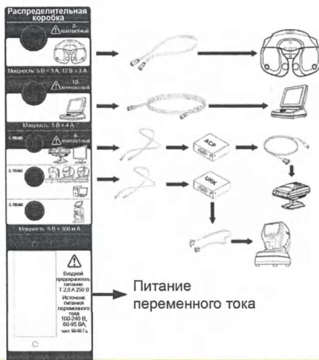
[Рисунок 4-11] Схема подключения UDR-800
