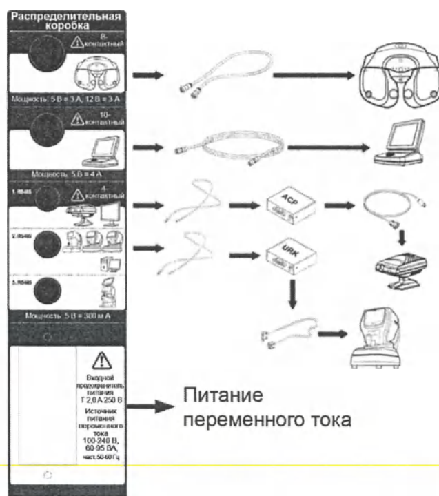
[Рисунок 4-11] Схема подключения UDR-800A
