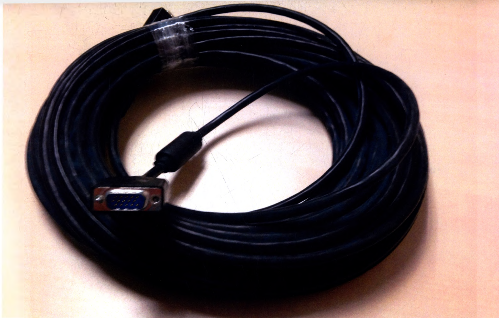
Кабели для подключения к генератору радиочастотному Maestro 4000. Общий вид( Кабель для подключения блока дистанционного управления, кабель для подключения системы записи EP (ЭФИ), кабель для подключения насоса MetriQ)
