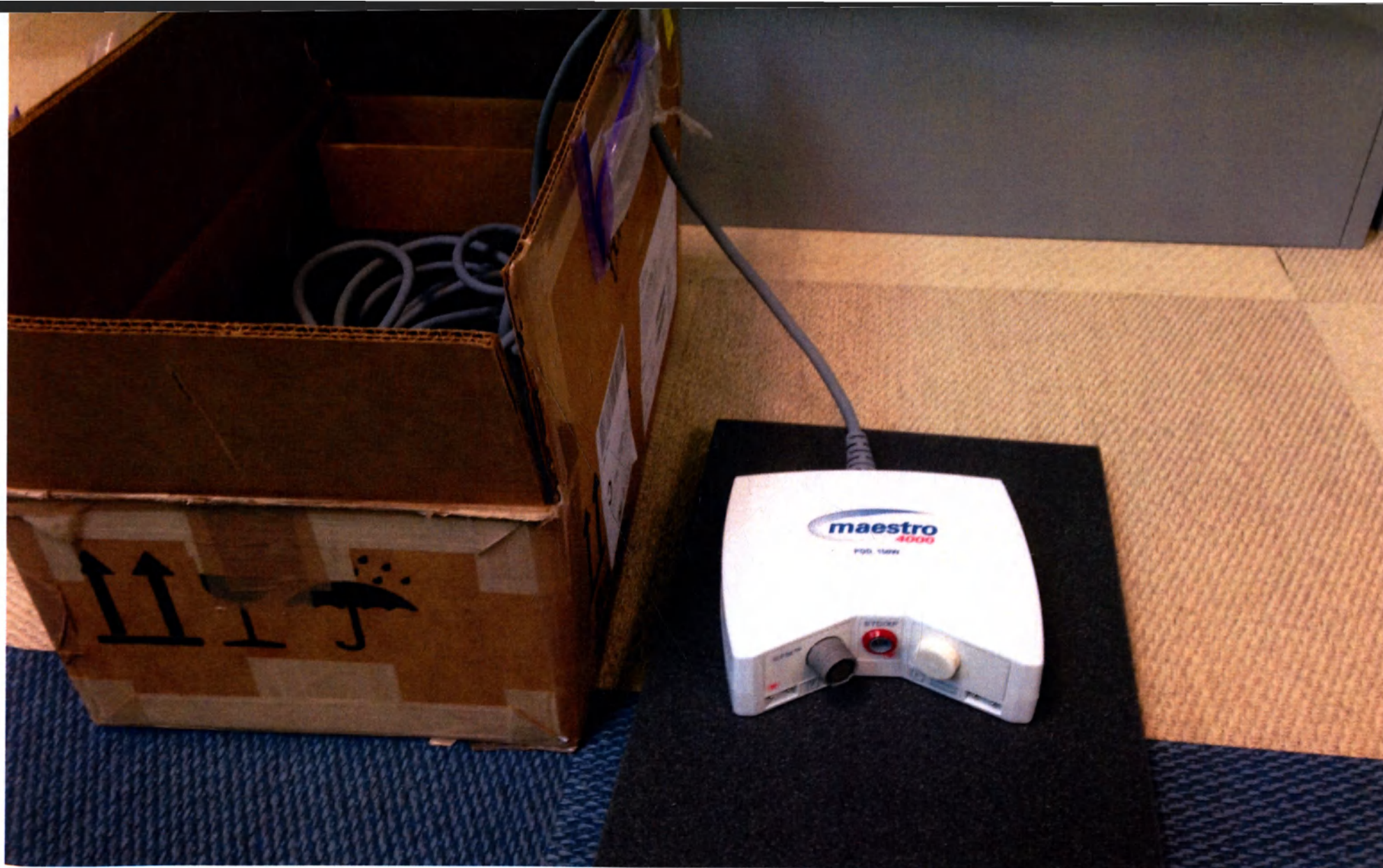
Модуль для подключения катетеров к РЧ генератору Maestro 4000 (Maestro 4000 Pod)
