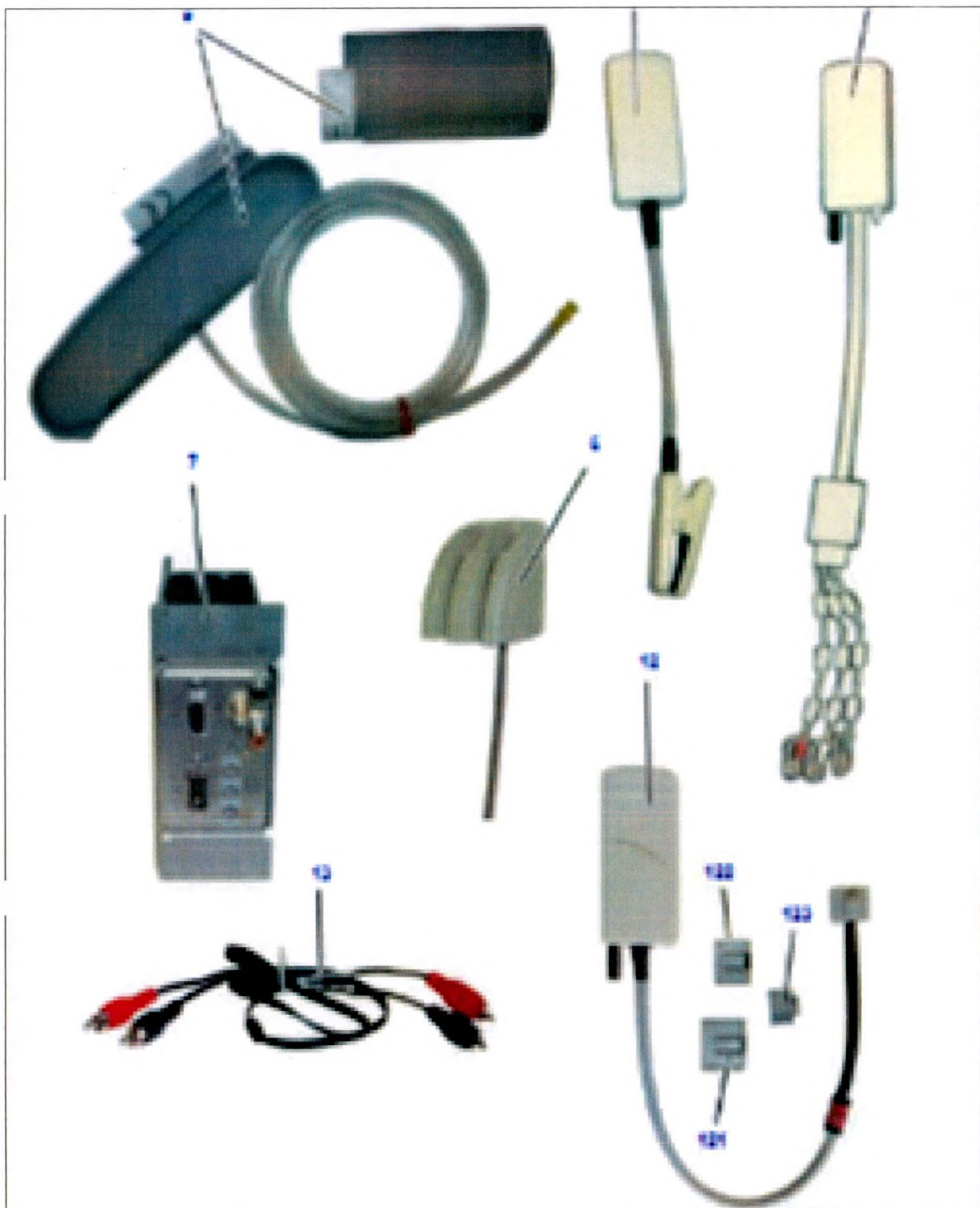
47. Блок для измерения физиологических параметров (при необходимости), в составе: датчик ЭКГ; датчик дыхания; - датчик пульса; вход внешнего сигнала запуска.
