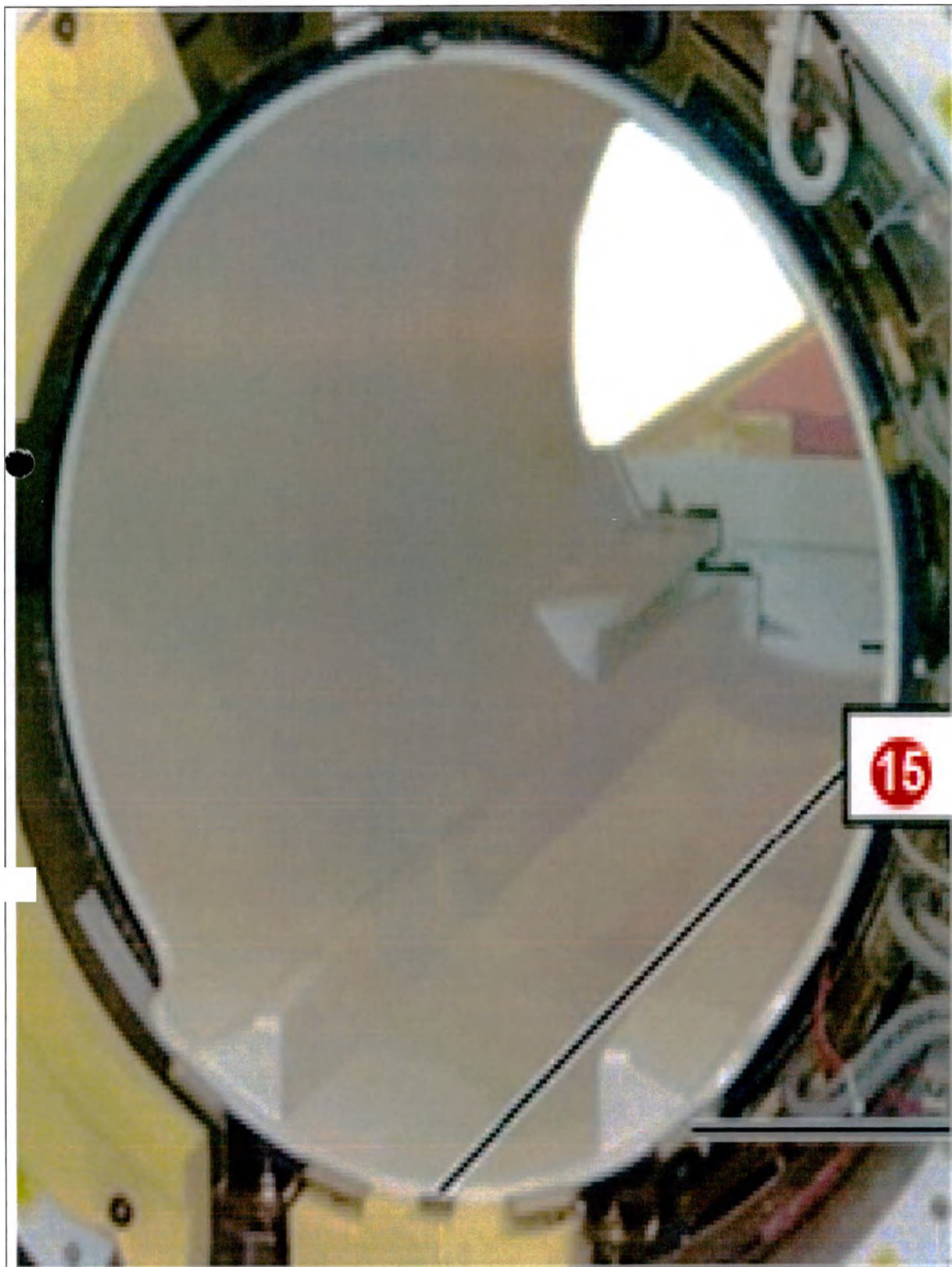
3. Катушка для тела, интегрированная в магнит.
