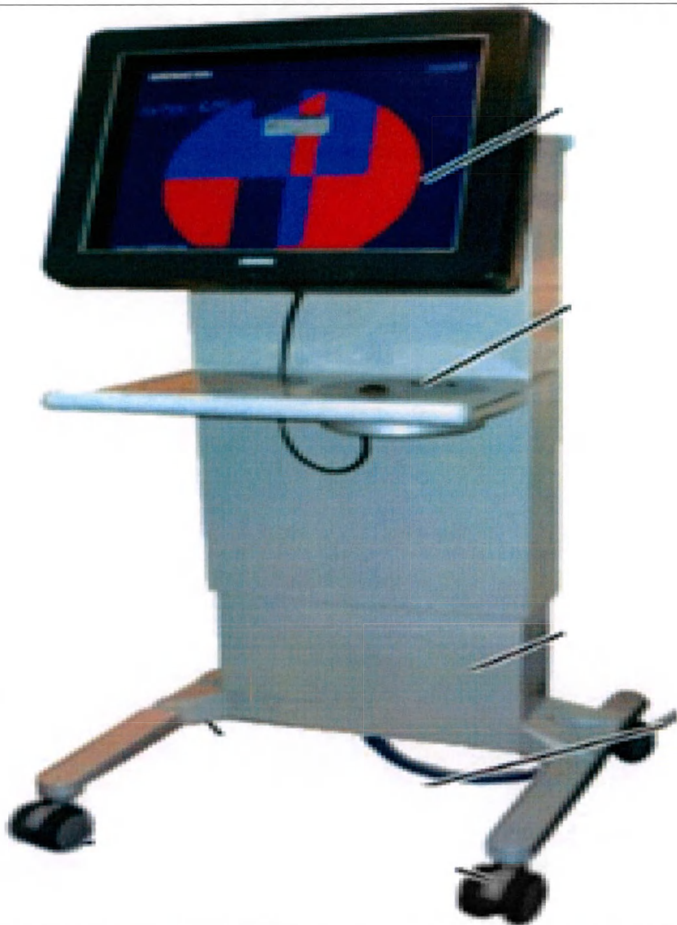
4. Дополнительная консоль управления в комнате для исследования, в составе: ЖК монитор; полка с шаровым манипулятором и клавишами.
