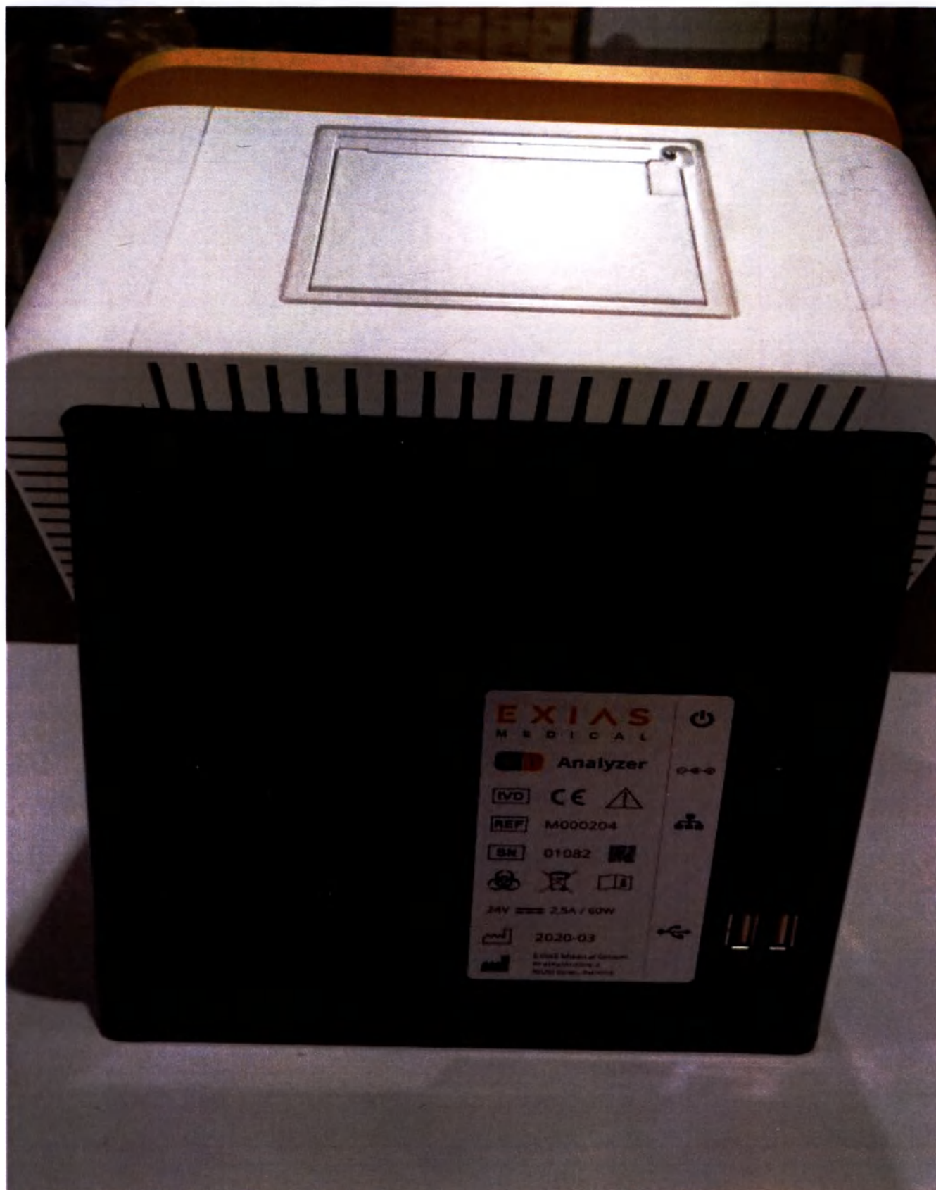
Рисунок 2. Анализатор е1 количественного определения электролитов, рН, гематокрита в цельной крови, сыворотке, плазме, растворе для диализа и водных растворах для лабораторной диагностики in vitro. Вид сзади
