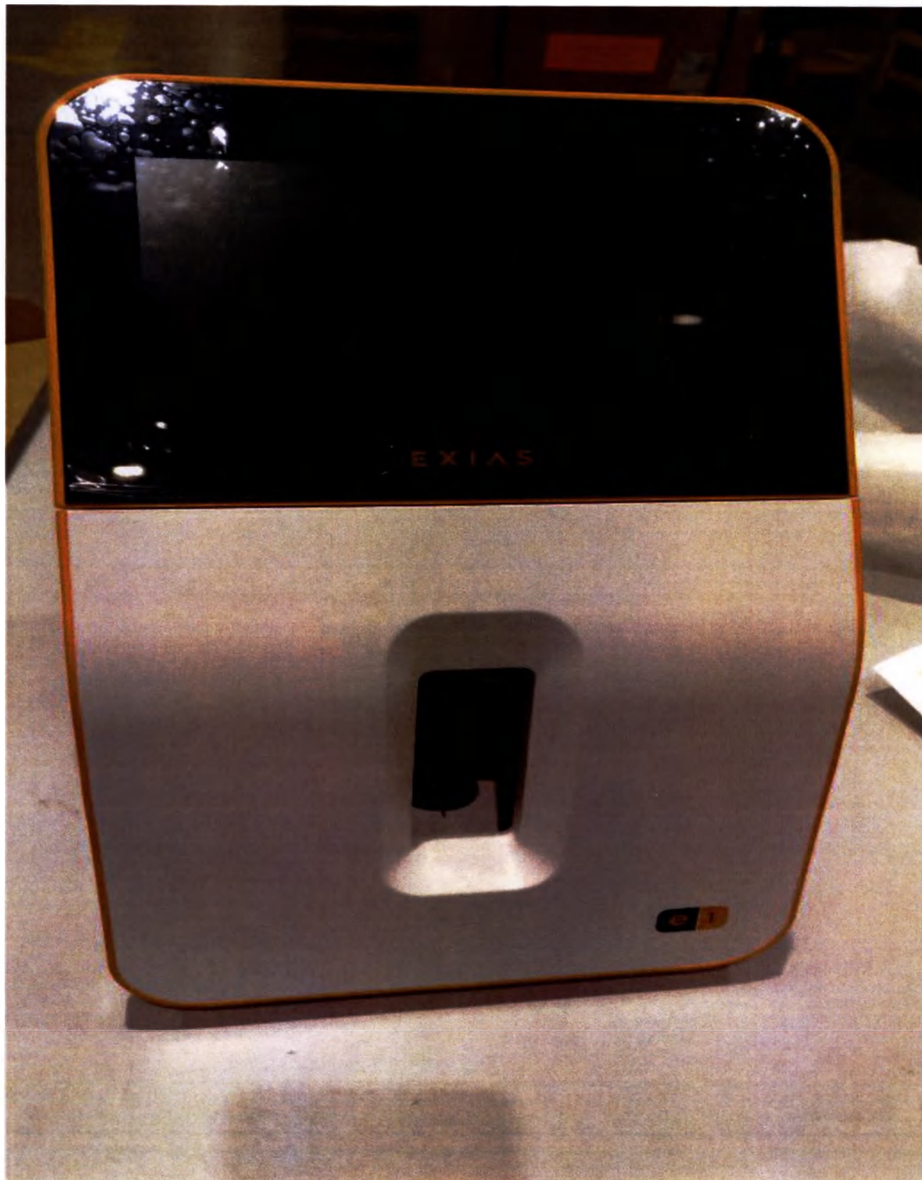
Рисунок 1. Анализатор е1 количественного определения электролитов, рН, гематокрита в цельной крови, сыворотке, плазме, растворе для диализа и водных растворах для лабораторной диагностики in vitro. Вид спереди
