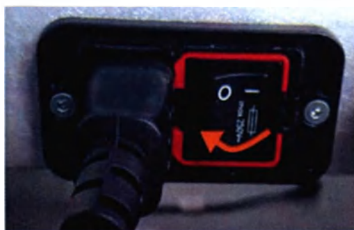
Рисунок 5.48 — выключатель питания в положении «выключено»
