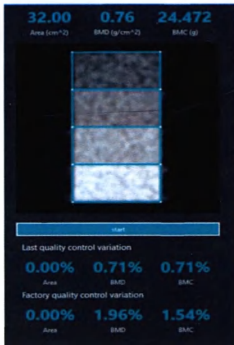
Рисунок 5.7 - скриншот фантомного изображения и успешного контроля качества
