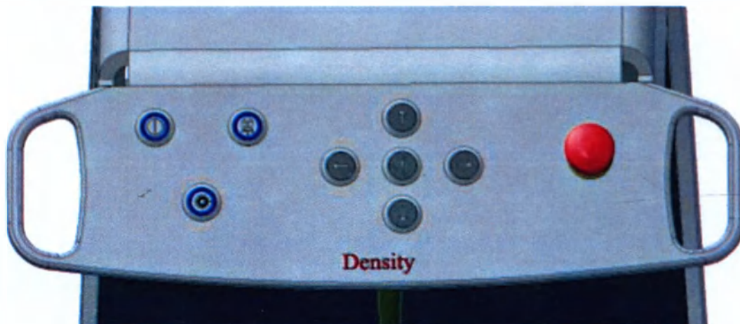
Рисунок 5.19 - Панель управления Density: стрелки и лазерный
