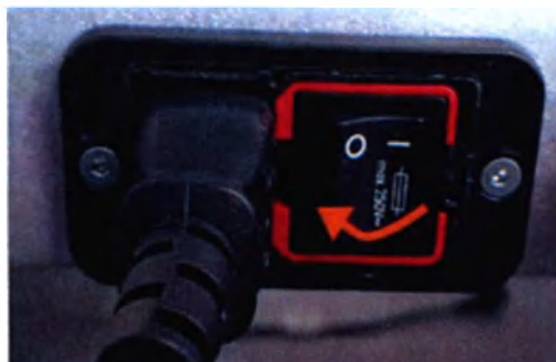
Рисунок 5.57 - выключатель питания в положении «выключено»
