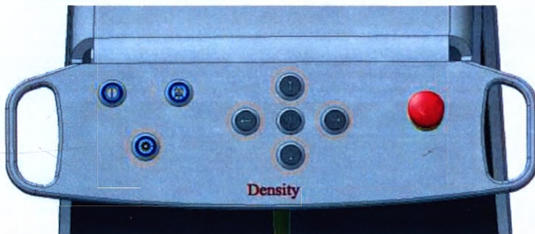
Рисунок 5.19 - Панель управления Density: стрелки и лазерный указатель. Чтобы подтвердить начало сканирования, необходимо нажать на панели управления:
