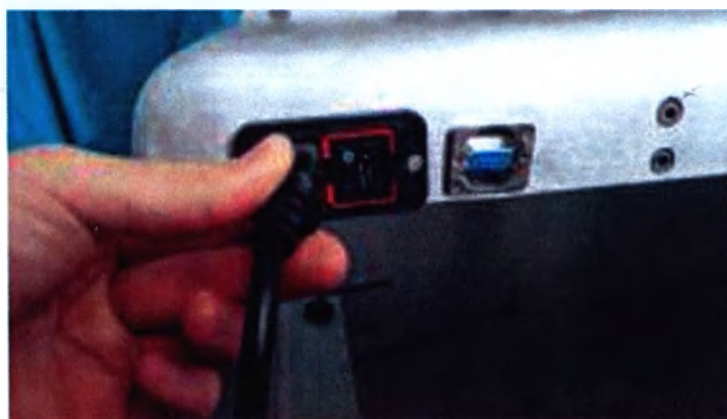
Рисунок 4.1 - расположение розетки с сетевым фильтром и подключение шнура питания.
