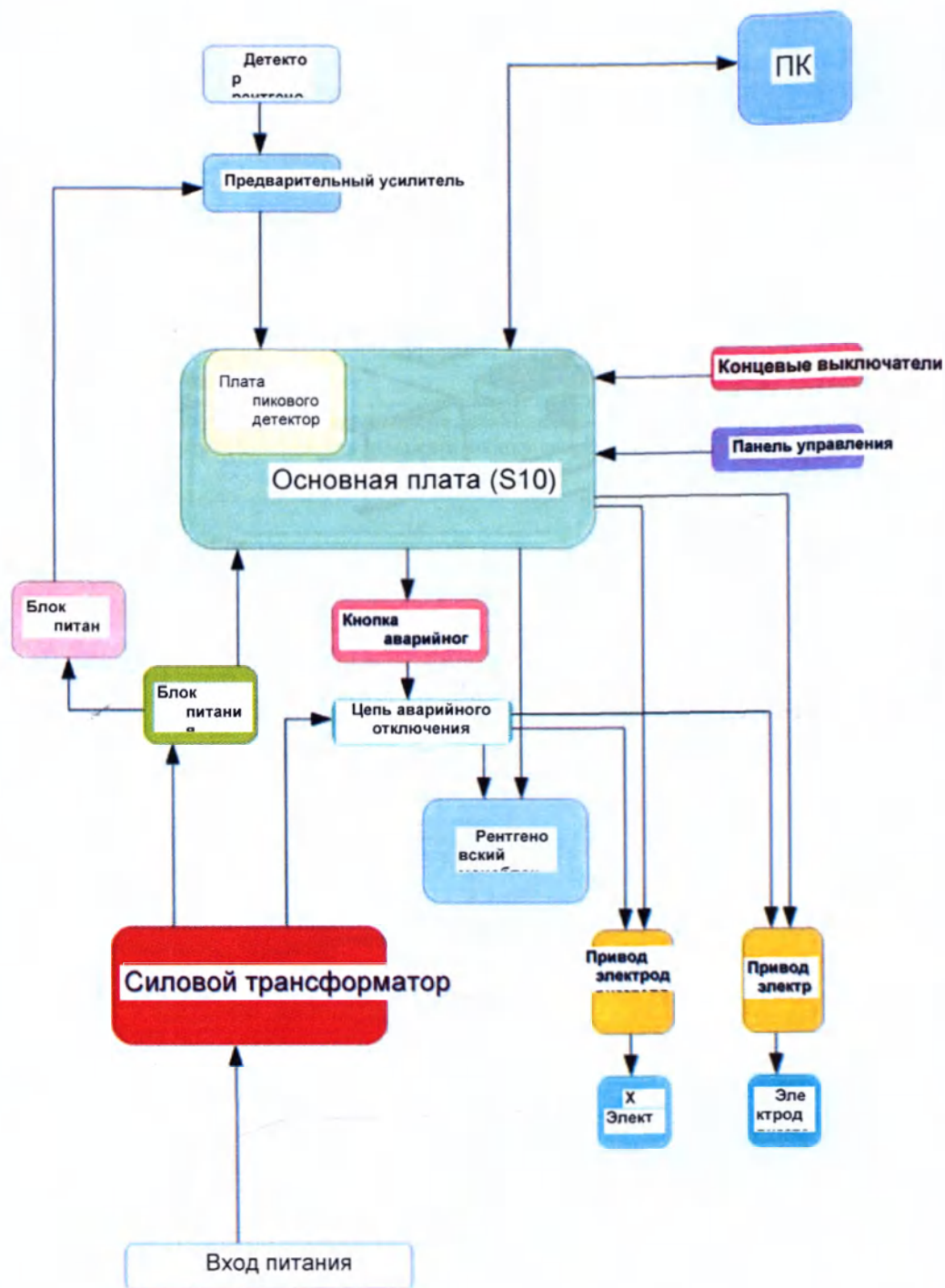
Рисунок 6.2 - Блок-схема связей между отдельными компонентами аппарата Density.
