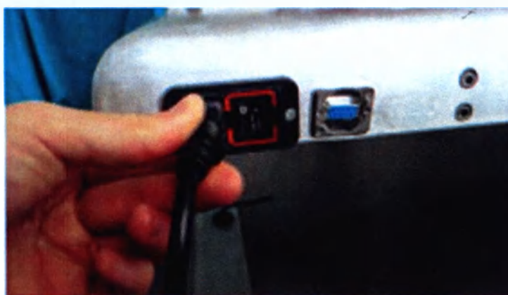
Рисунок 4.4 — подключение шнура питания к аппарату.
