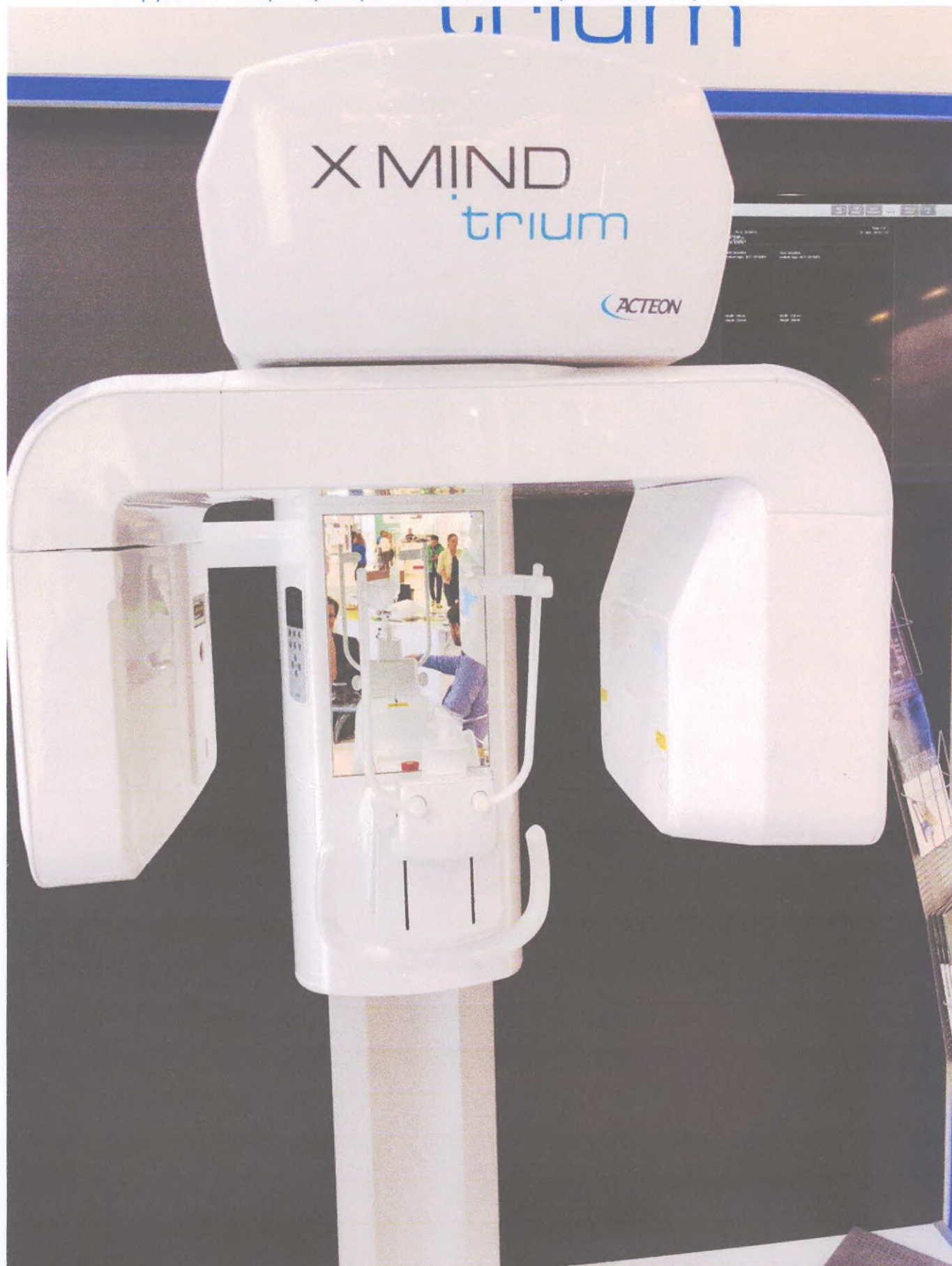
2. U-Группа с генератором рентгеновского излучения, в сборе
