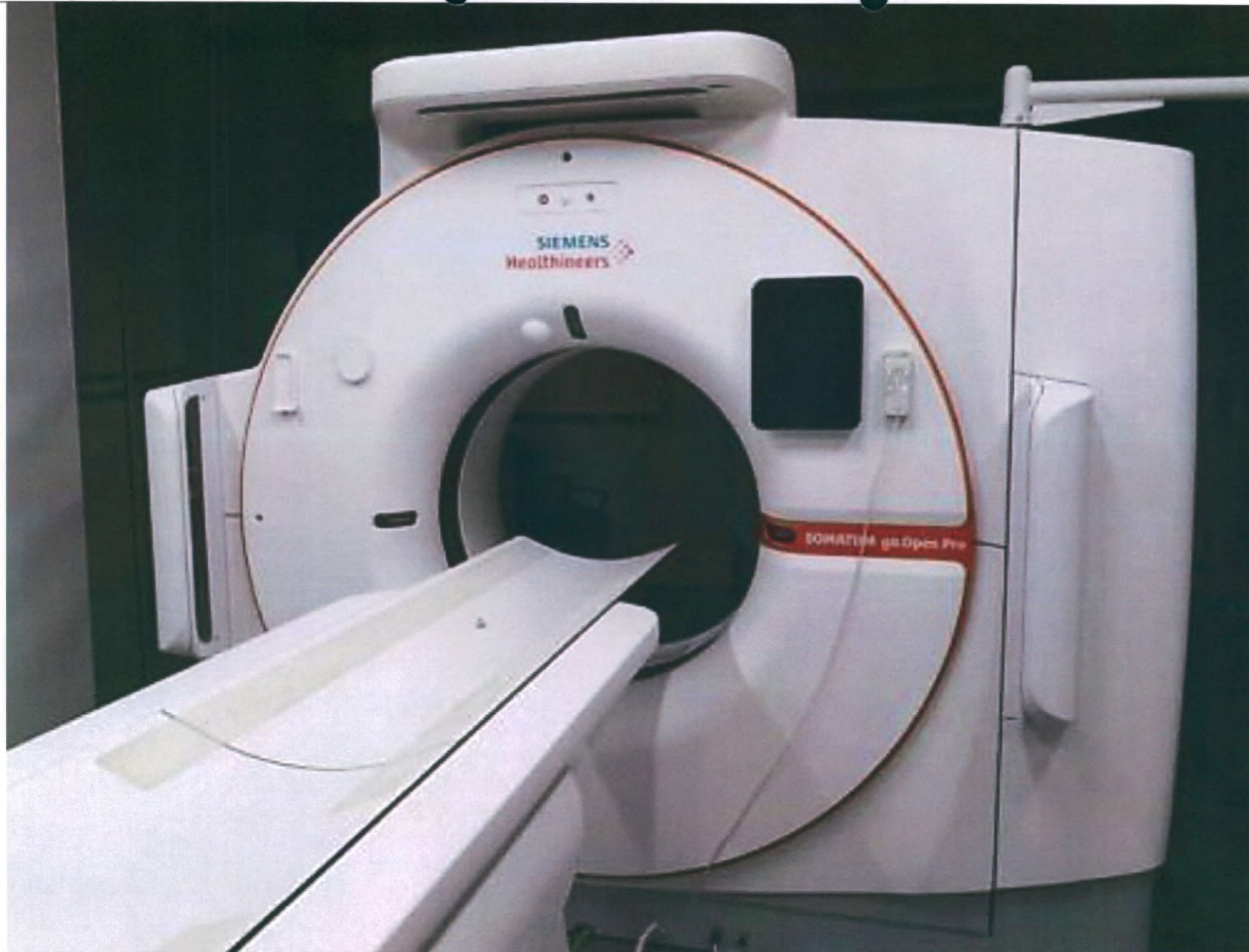
1. Гентри в составе: рентгеновская трубка; коллиматор трубки; детектор; кожух гентри; генератор; проводной пульт дистанционного управления сканером.
