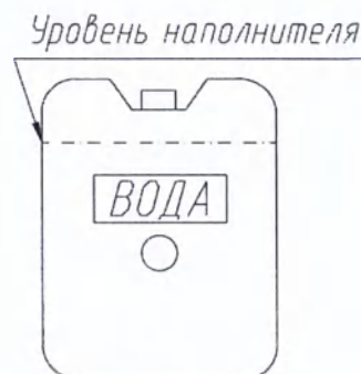
Рис. 2 Уровень заполнения аккумулятора холода наполнителем
