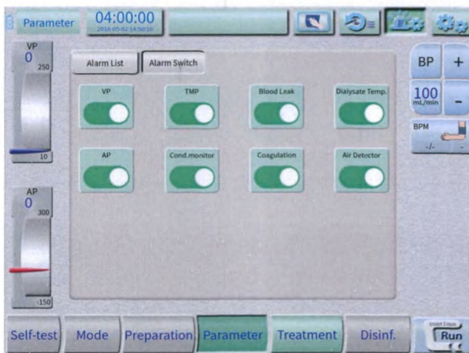
Рис.66. Настройка параметров аварийных сигналов
