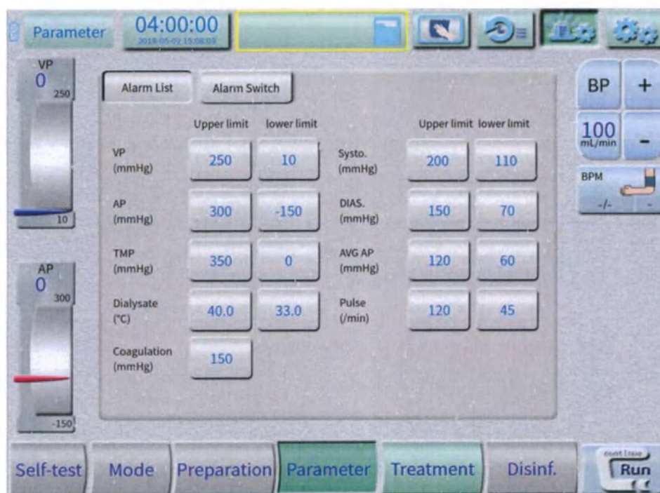
Рис.73. Настройка пределов срабатывания аварийного сигнала кровяного давления Когда результаты измерения давления пациента превышают установленный для сигнала предел, на экране появится соответствующее сообщение
