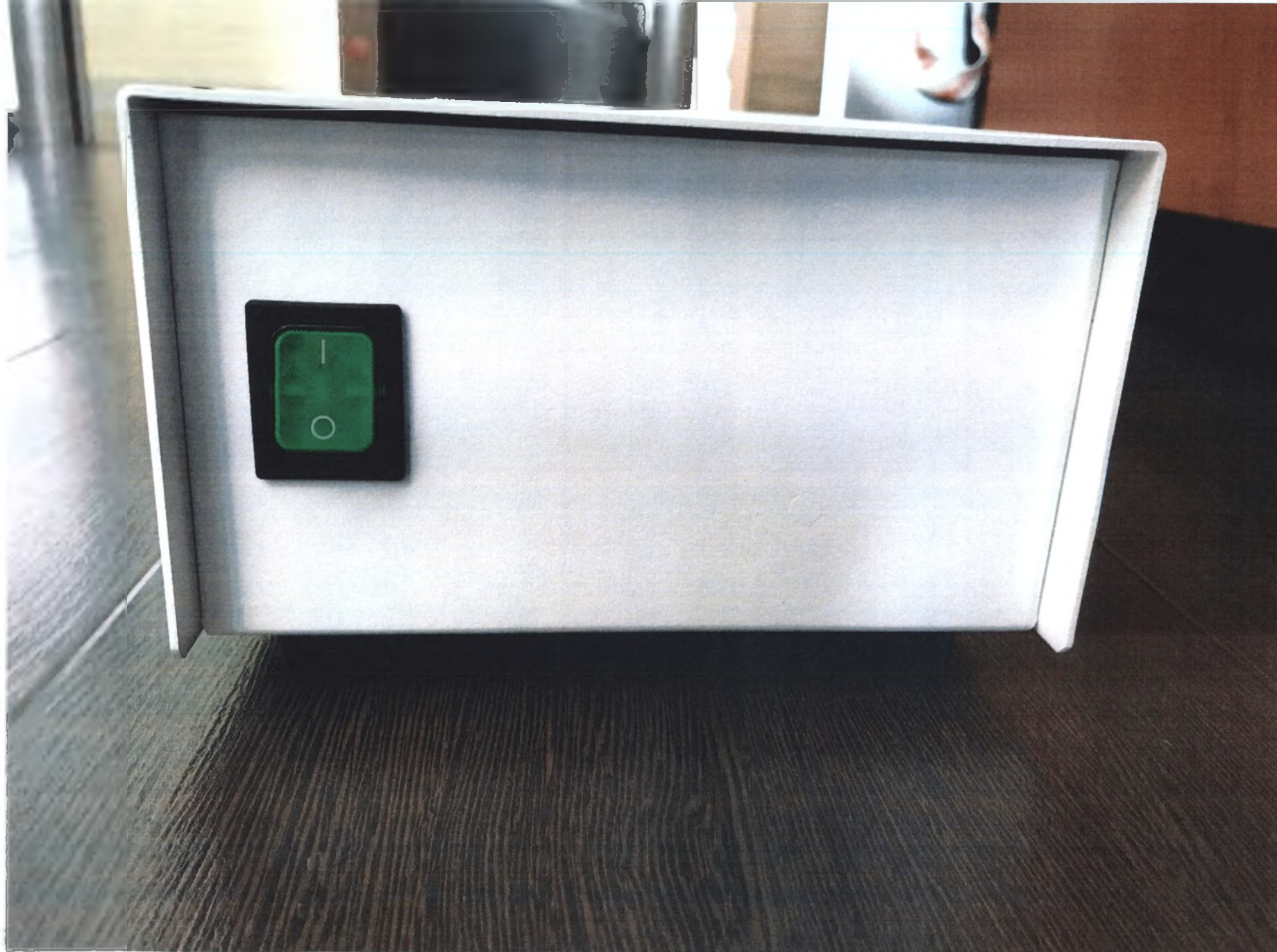
Изолирующий трансформатор (по необходимости) в наборе (вид спереди) [Серийный номер 89520 5621; Дата производства 30.06.2016]
