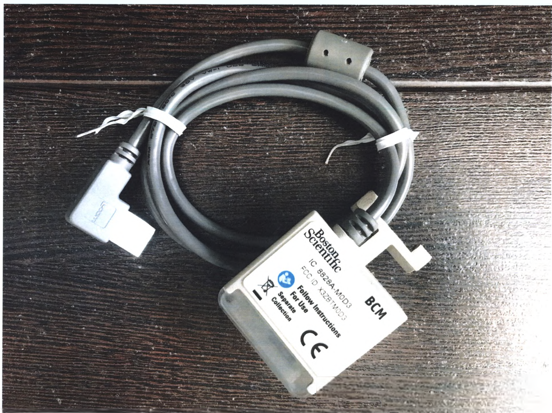
Модуль связи Bluetooth FFR Link Bluetooth Communication Module (вид сверху) [Лог 20758792; Дата производства 12.06.2017]
