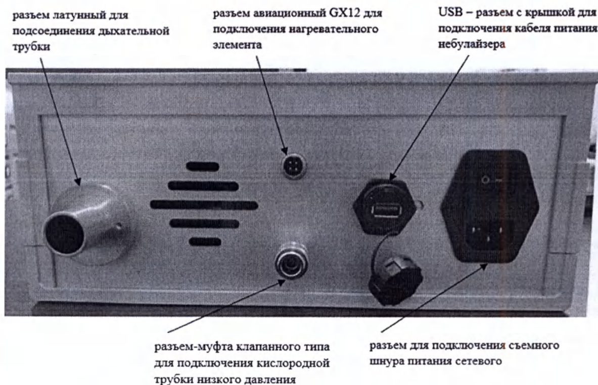
Рисунок 6 – Разъемы на задней поверхности блока управления
