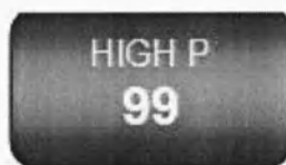
Рис. 25: установка верхнего ограничения давления, при котором срабатывает сигнализация
