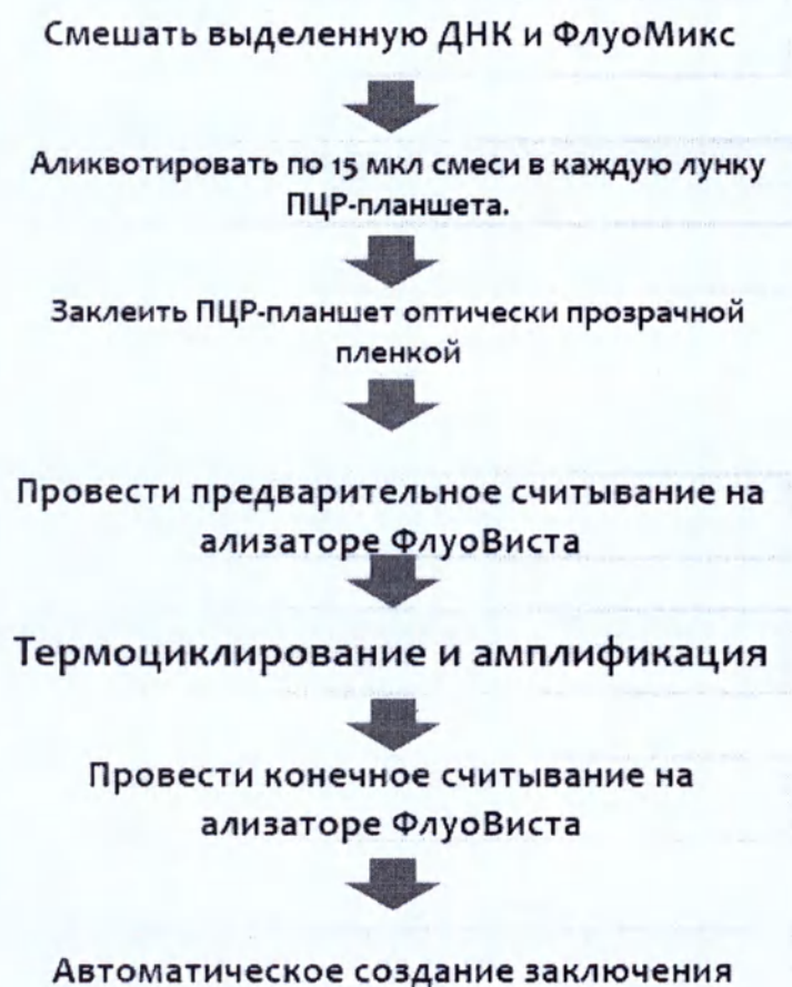
Рис. 1 – схема проведения исследования с помощью наборов НРА-FluoGene.
