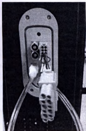
Рис. 19.4 Вид подключенного набора для тестирования аппарата к месту соединения коннектора манипулы.
