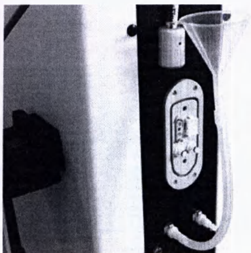
Рис. 15.5 Расположение водоприемников, воронки и клапана для воронки.
