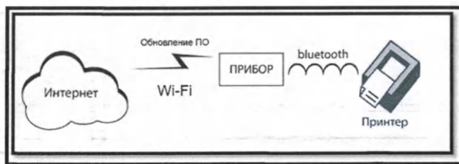
Рисунок 3 - Схема беспроводных интерфейсов анализатора
