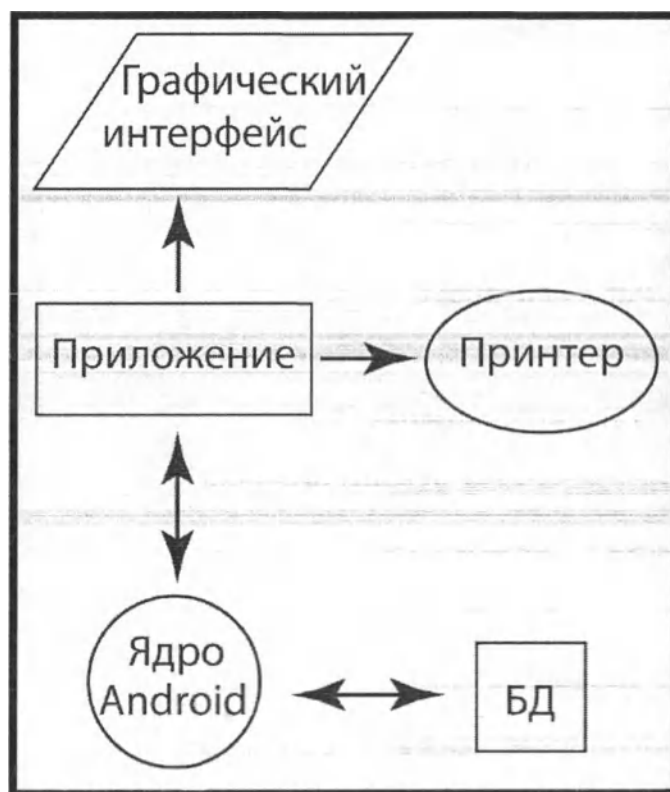
Рисунок 7 - Структурная схема операционной системы и приложения
