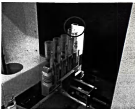
Рис. Е-4 Выступающая пробирка блокирует выход штатива
