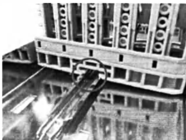
Рис. С-34 Штатив не вставлен в направляющий полозок
