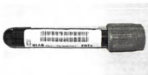
Рис. А-35 Ширина линий штрих-кода непостоянна, прерывающийся штрих-код
