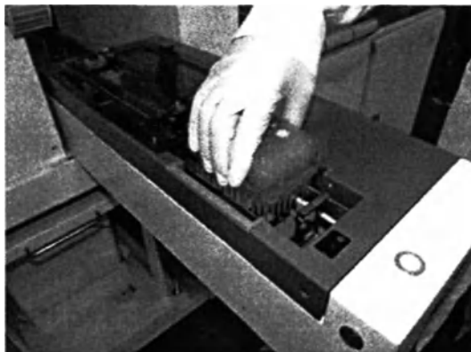
Рисунок 4. Установка штативов с наконечниками
