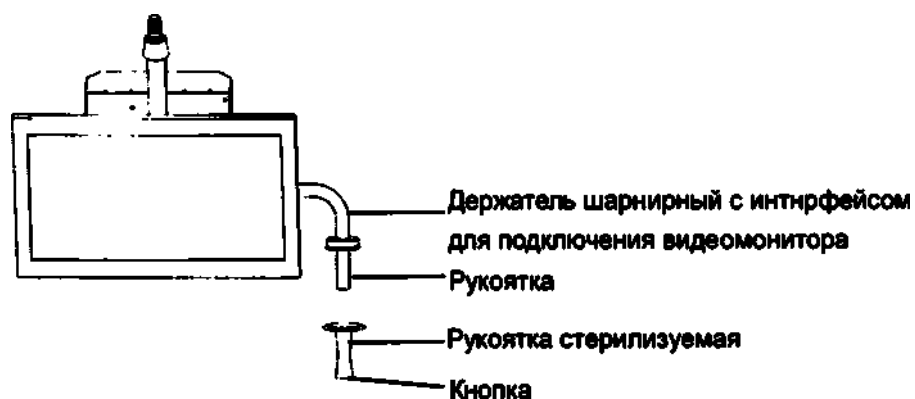
Рисунок 2-28. Установка / Снятие рукоятки стерилизуемой на держатель шарнирный с интерфейсом для подключения видеомонитора
