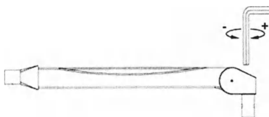
Рисунок 3-10. Регулировка кронштейна пружинного светильника HyLED 8600M
