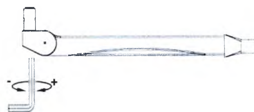
Рисунок 3-9. Регулировка кронштейна пружинного для использования в помещениях с низким потолком
