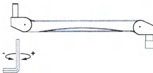
Рисунок 3-8. Регулировка кронштейна пружинного стандартного
