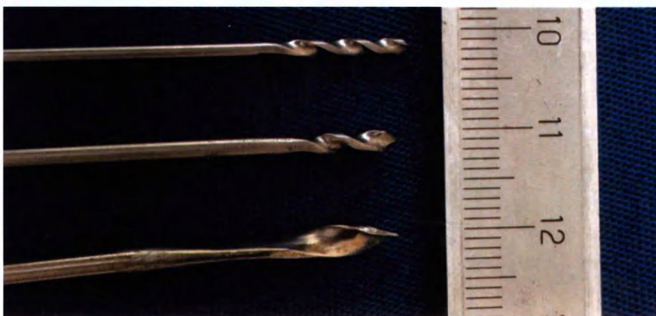
Рис. 24. Сверла костные для прохождения костных преград. Длина инструментов 250 мм.
