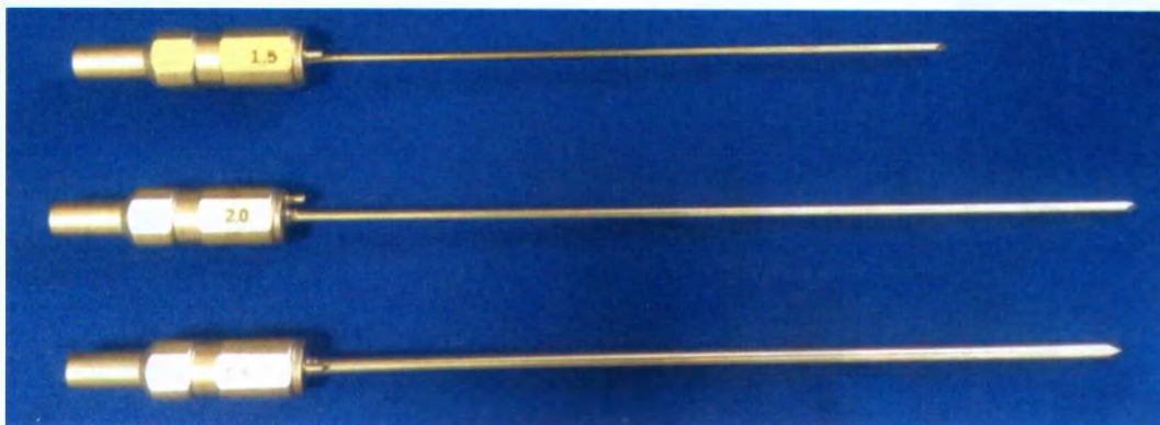
Рис.22. Трепаны диаметром 1,5, 2,0, 3,0. Отличаются от обычных пилотных стилетов четырехгранной ручкой с кольцевой проточкой.
