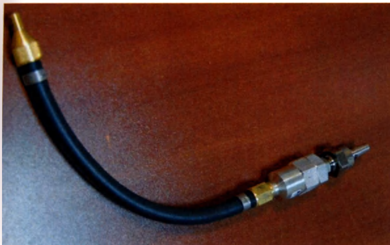
Шланг с адаптером для подключения баллона со сжатым воздухом. Для работы под давлением 620-825 кПА.
