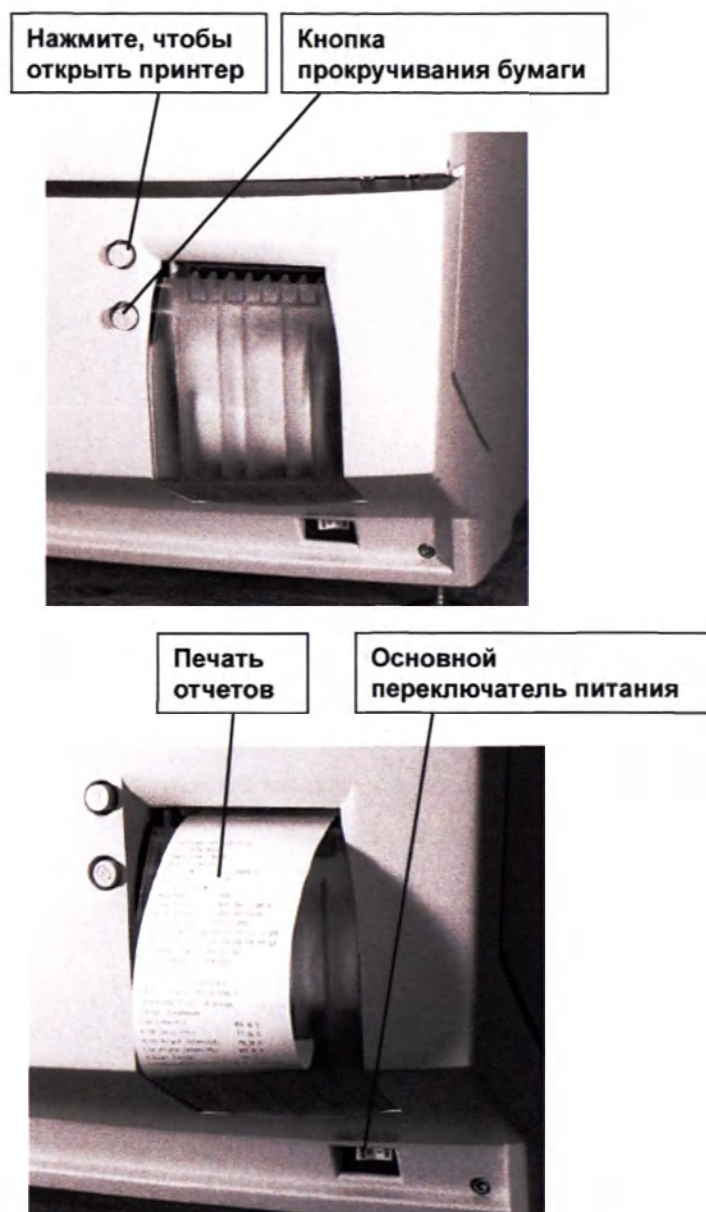
Рис. 5. Принтер STERRAD® NX®, кнопка прокручивания бумаги, переключатель питания.
