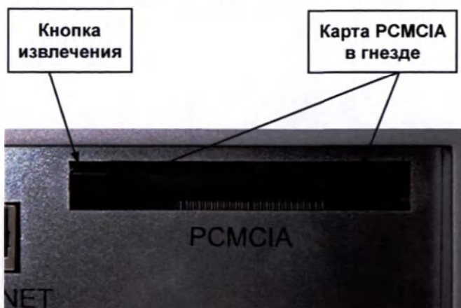
Рисунок 68. Карта PCMCIA, установленная в гнездо. Ваша система может выглядеть несколько иначе.
