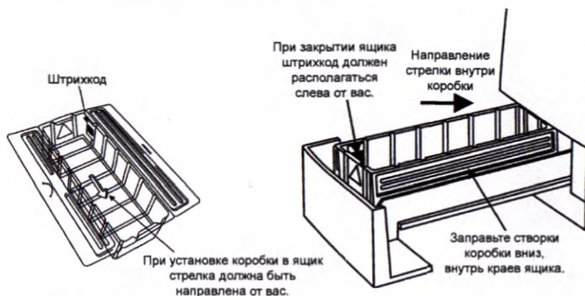
Рис. 48. Правильное расположение коробки для кассет в ящике. Обратите внимание на то, в каком направлении указывает стрелка внутри коробки
