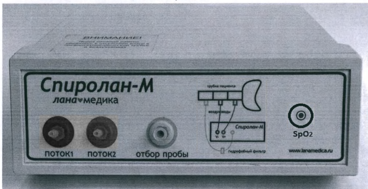
Рисунок 1 - Блок преобразования сигналов (передняя панель)
