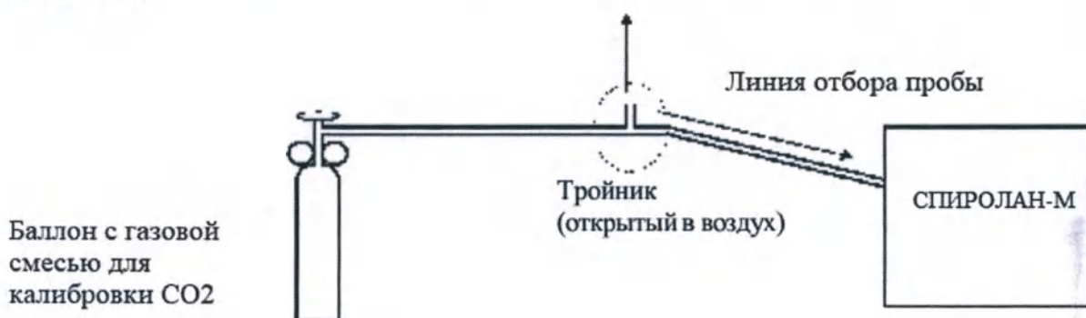
Рисунок 78 – Схема подключения баллона с эталонной концентрацией \text{CO}_2 для калибровки блока газоанализа.
