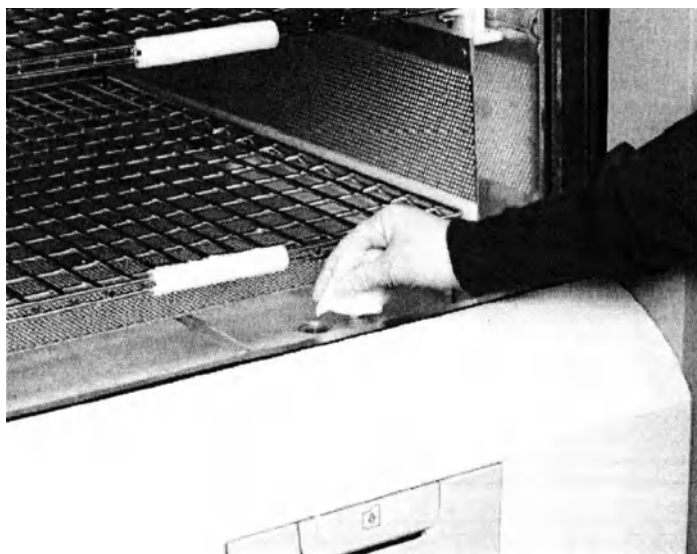
Рисунок 33. Очистка линзы монитора пероксида водорода.
