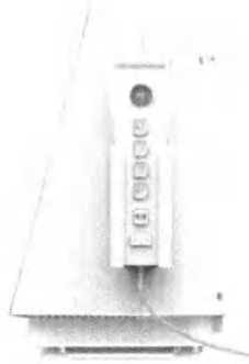
Şekil 4. Symplicity G3™ renal denervasyon RF jeneratörünün yan panelinde, kılıf içinde saklanan Uzaktan Kumanda. Uzaktan kumanda, bahsedildiği gibi dokunmatik ekranın kontrol işlevselliklerinin bazılarını tekrarlar.
