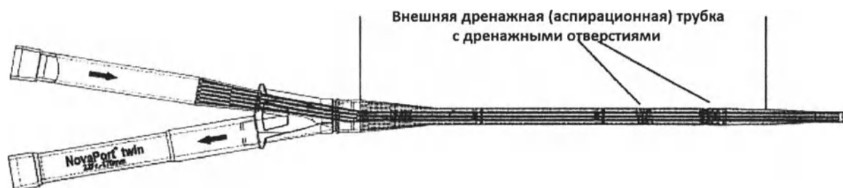
Рисунок 20. Внешняя дренажная (аспирационная) трубка
