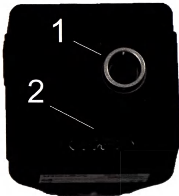
Рисунок 77 - Камера CAM V3200. Вид сзади: 1 – 8-контактный разъем GPI/O, 2 – разъем USB 3.1
