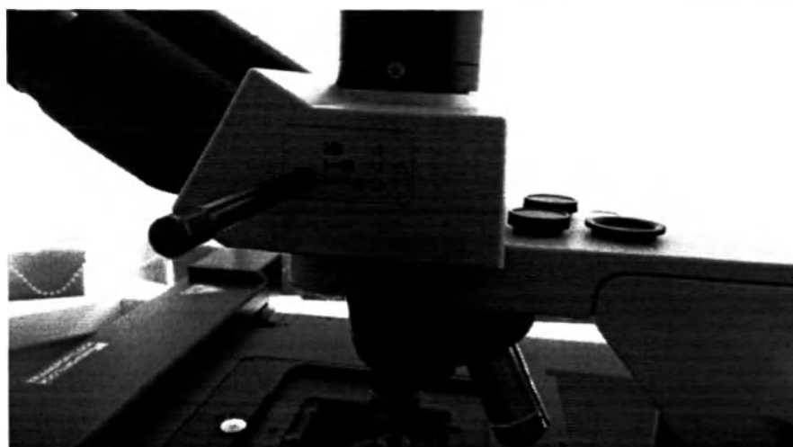
Рисунок 22 - Ручка светоделителя занимает среднее положение: 20% света поступает в окуляры, 80% - в порт камеры
