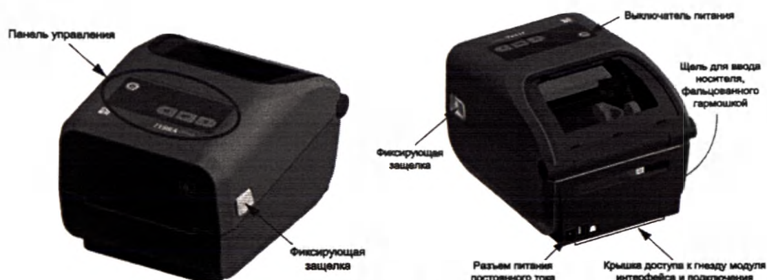
Рисунок 107 - Функциональные элементы принтера этикеток слайдов
