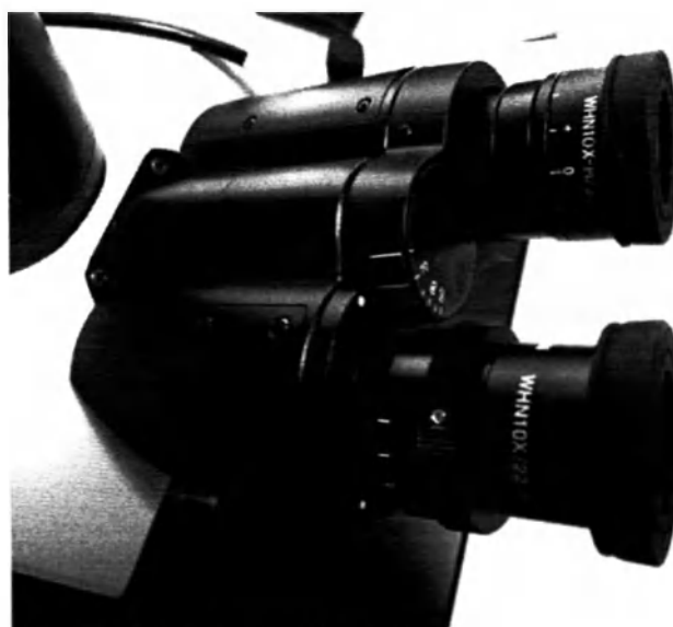
Рисунок 27 – окуляры, применяемые в системе, установленные в окулярные трубки микроскопа BX43F
