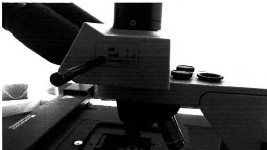
Рисунок 23 - Ручка светоделителя максимально выдвинута из корпуса тринокулярной головки: весь свет поступает в порт камеры
