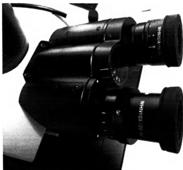
Рисунок 27 – окуляры, применяемые в системе, установленные в окулярные трубки микроскопа BX43F
