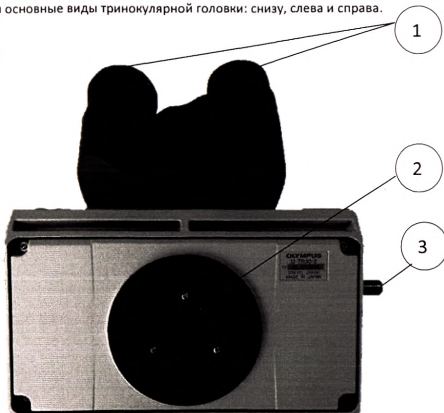
Рисунок 18 - Тринокулярная головка. Вид снизу: ① – окулярные трубки, ② – крепление «ласточкин хвост», ③ – ручка светоделителя.
