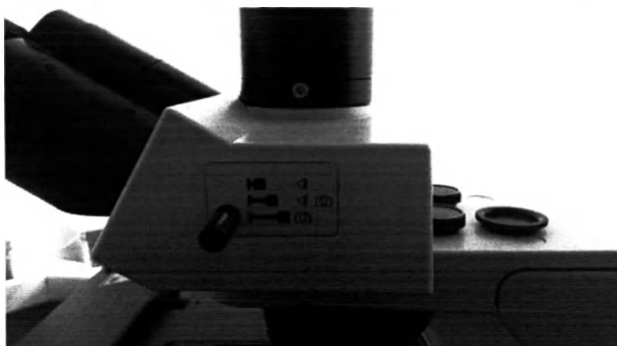
Рисунок 21 – Ручка светоделителя до возможного предела «утоплена» в корпус тринокулярной головки: изображение передается только в окуляры микроскопа
