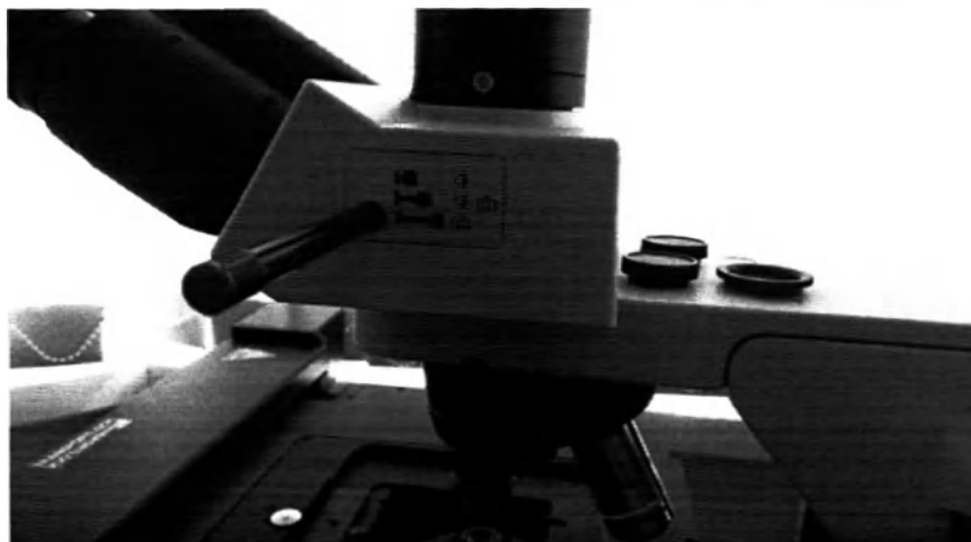
Рисунок 22 - Ручка светоделителя занимает среднее положение: 20% света поступает в окуляры, 80% - в порт камеры
