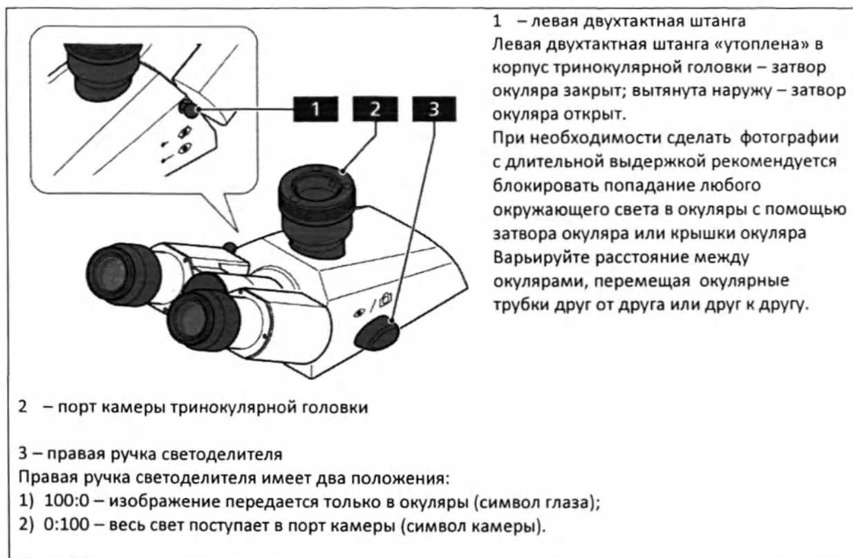
Рисунок 12 – элементы тринокулярной головки
