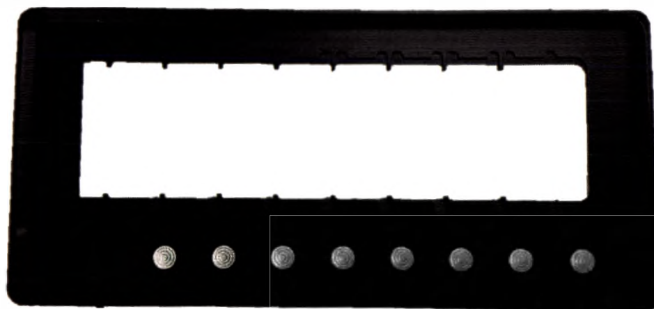
Рисунок 39 - Кассета для слайдов для одновременного размещения до 8-ми предметных стекол
