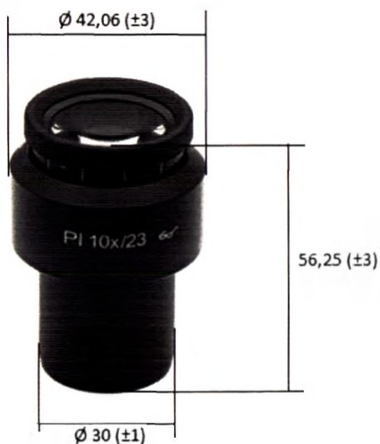
Рисунок 15 – Общий вид и габаритные размеры окуляра PL10x/23 (в комплекте 2 шт.) Окуляры имеют резиновый защитный наконечник на окуляр (Рисунок 15) для предохранения от царапин, а также для исключения попадания света в область между глазом и окуляром во время работы с микроскопом.
