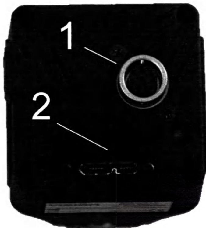
Рисунок 81 - Камера CAM V3400. Вид сзади: 1 – 8-контактный разъем GPI/O, 2 – разъем USB 3.1
