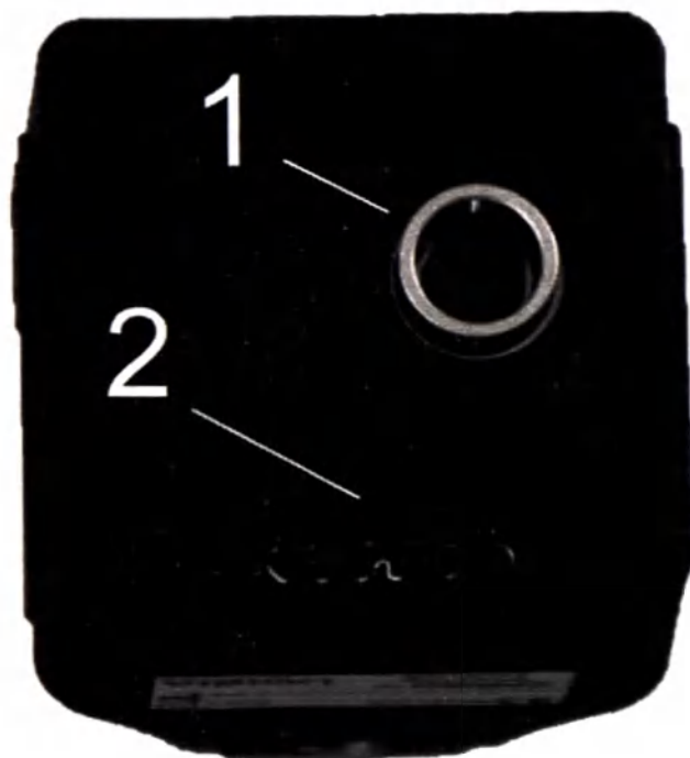
Рисунок 91 - Камера CAM V3200. Вид сзади: 1 – 8-контактный разъем GPI/O, 2 – разъем USB 3.1
