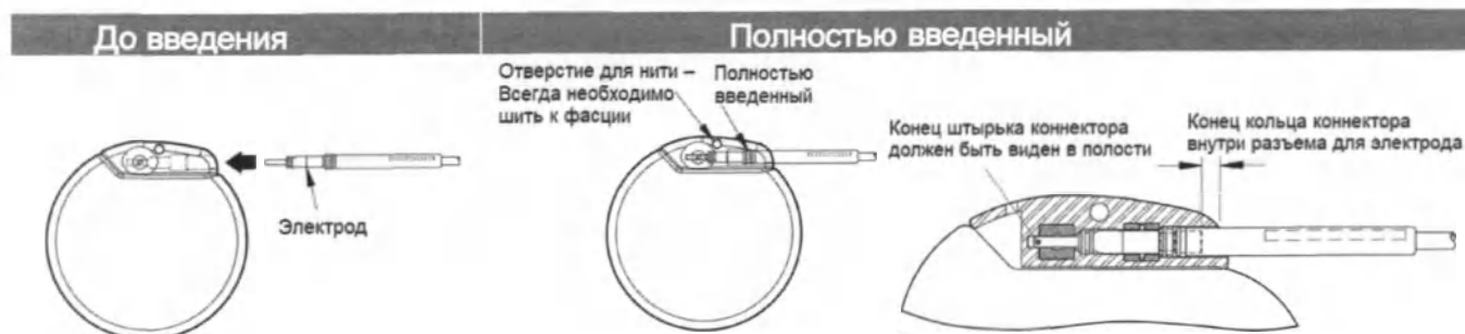
Рисунок 34. Коннектор электрода до введения и полностью введенный
