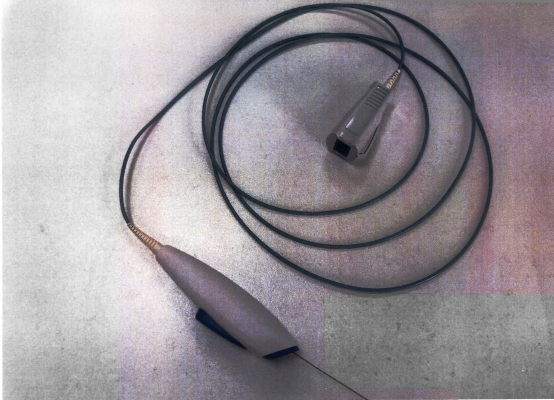
Оптический соединительный кабель в сборе (состоит из кабеля, рукоятки и кожуха), принадлежащий МИ «Проводник Comet II для определения давления в коронарных сосудах»
