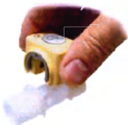
Установка датчика CO 2 на адаптер
