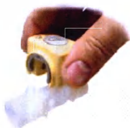
Установка датчика \text{CO}_2 на адаптер
