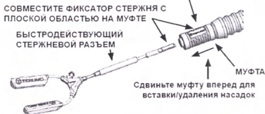
Рисунок 4 — Присоединение вспомогательного устройства к универсальному рычагу-стабилизатору Hercules™ 3 (идентификационный номер изделия T401161)
