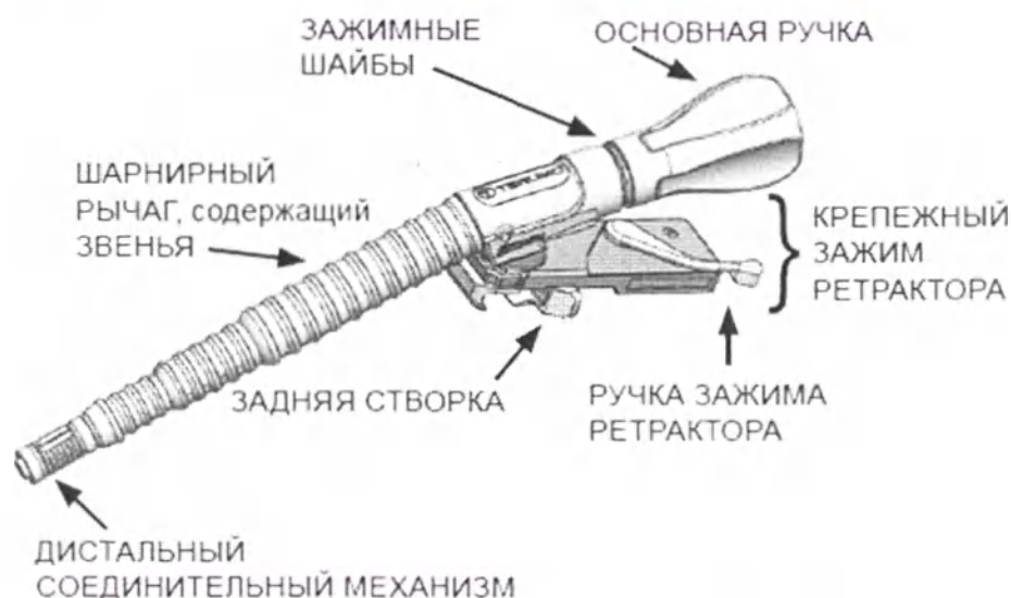
Рисунок 1 — Универсальный рычаг-стабилизатор Hercules™ 3
