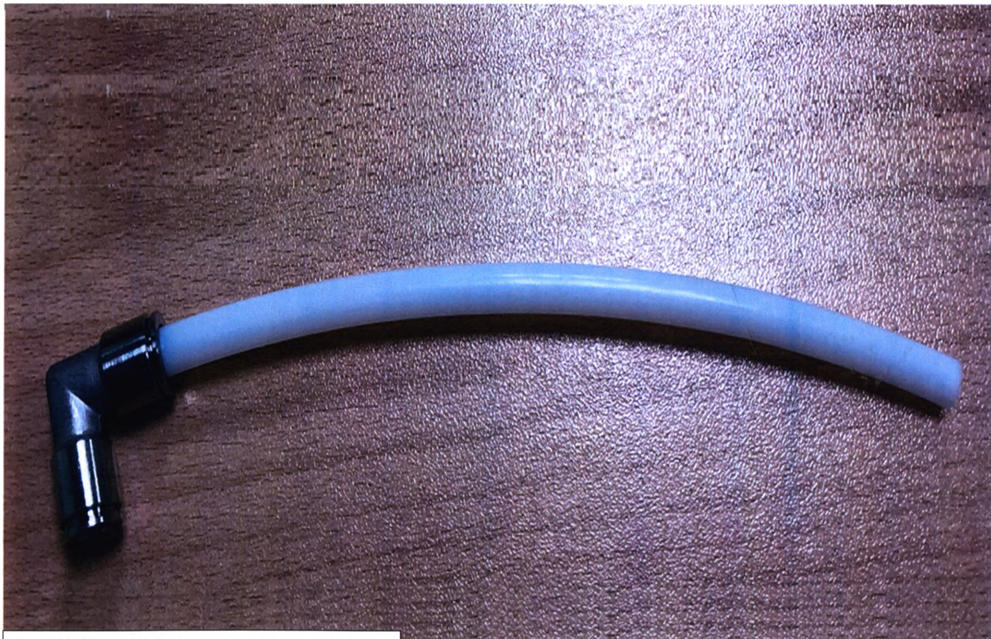
Фото 20. Шланг для подачи газа внутри печи.
