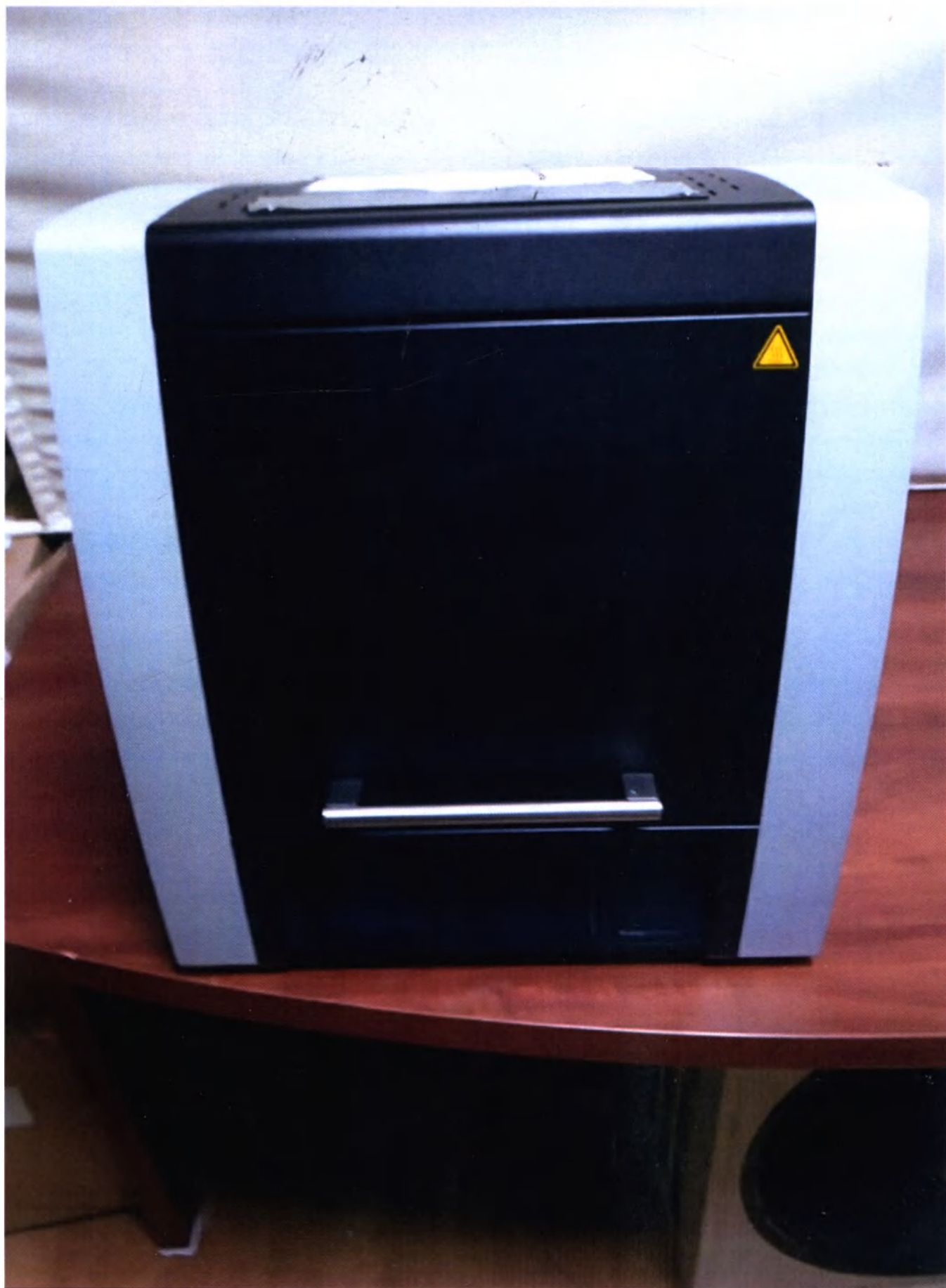
Фото 1. Печь для синтеризации диоксида циркония Ceramill Therm 3
