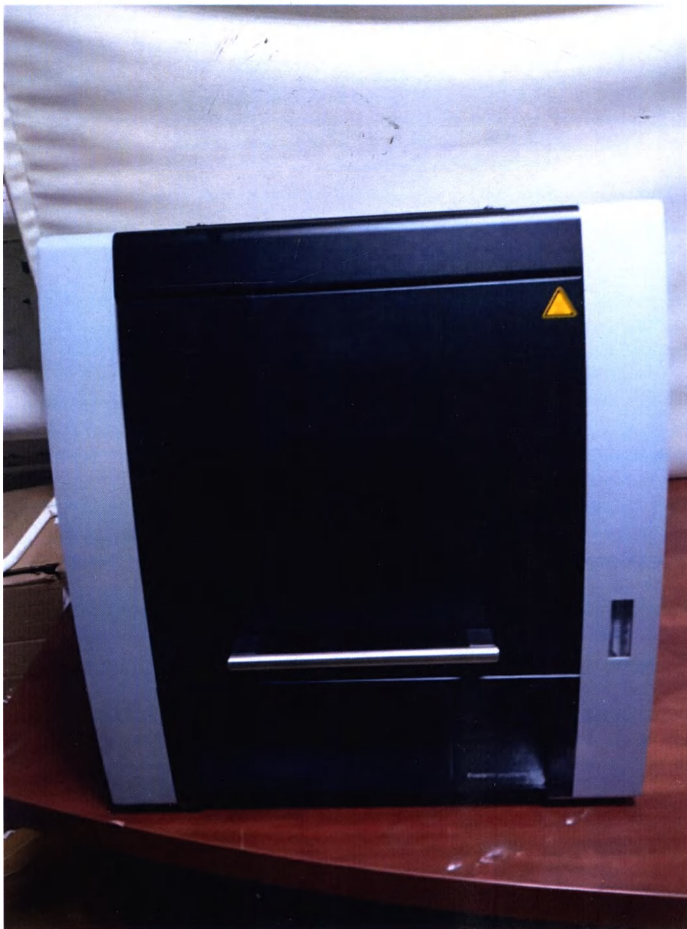
Фото 2. Печь для синтеризации кобальт-хромового сплава Ceramill Argotherm 2.
