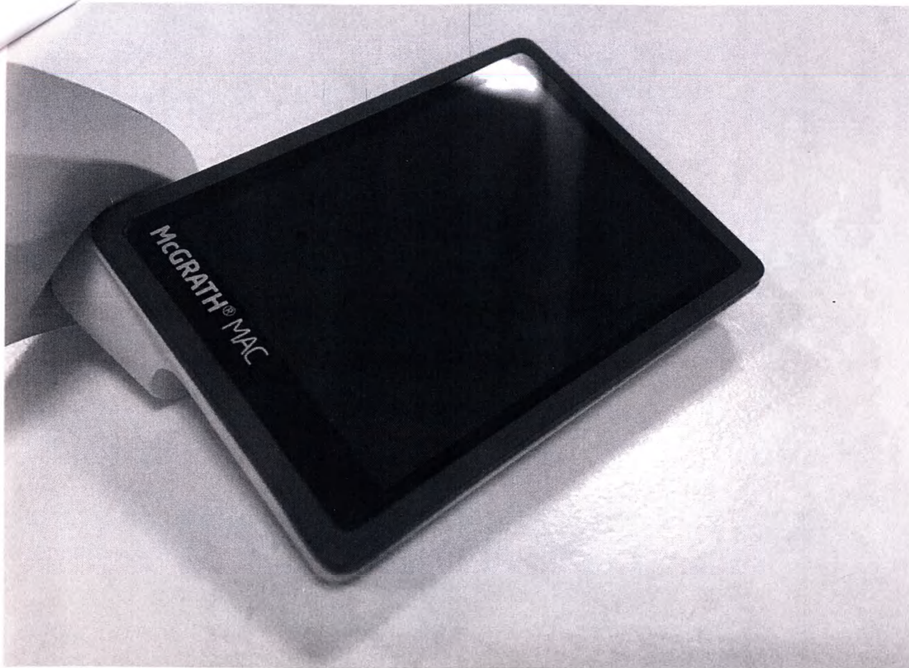
Фото 2. LCD ЖК-дисплей цветной 2,5 дюйма
