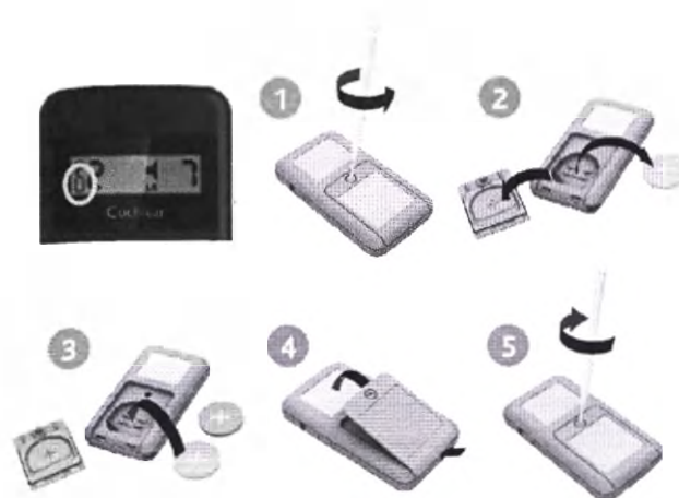
Рисунок 9.24 – Замена элемента питания пульта ДУ.
