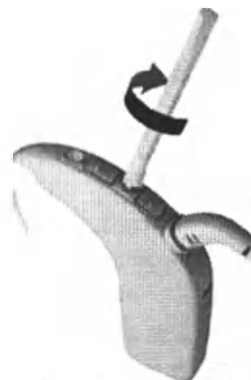
Рисунок 9.14 – Процесс извлечения защиты микрофона
