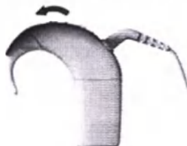
Рисунок 9.17 – Процесс установки защиты микрофонов
