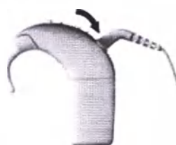
Рисунок 9.16 – Процесс установки защиты микрофонов
