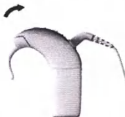
Рисунок 9.19 – Процесс установки защиты микрофонов
