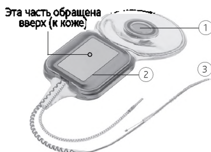
Рис. 2. Кохлеарный имплант CI512 с электродной решеткой Contour Advance (сторона, обращенная к коже)
