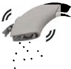
Если в процессор попадает песок или грязь, необходимо аккуратно вытряхнуть загрязнение из компонентов и заменить защиту микрофонов.
