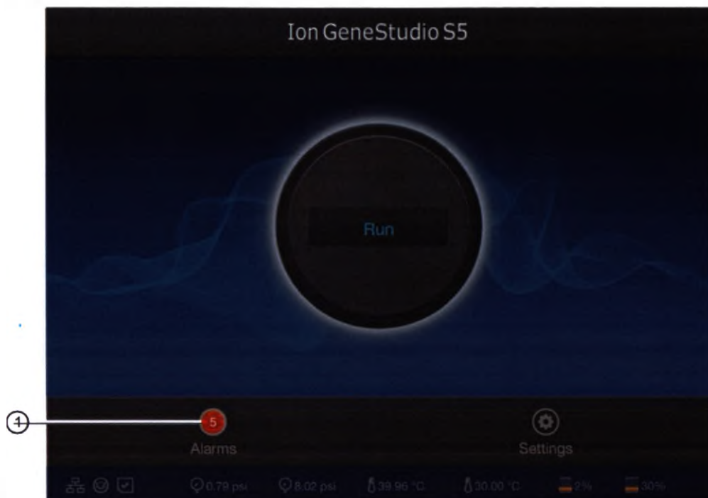
(1) индикатор «Alarms/Notifications» (Сигналы об ошибках/Уведомления)
