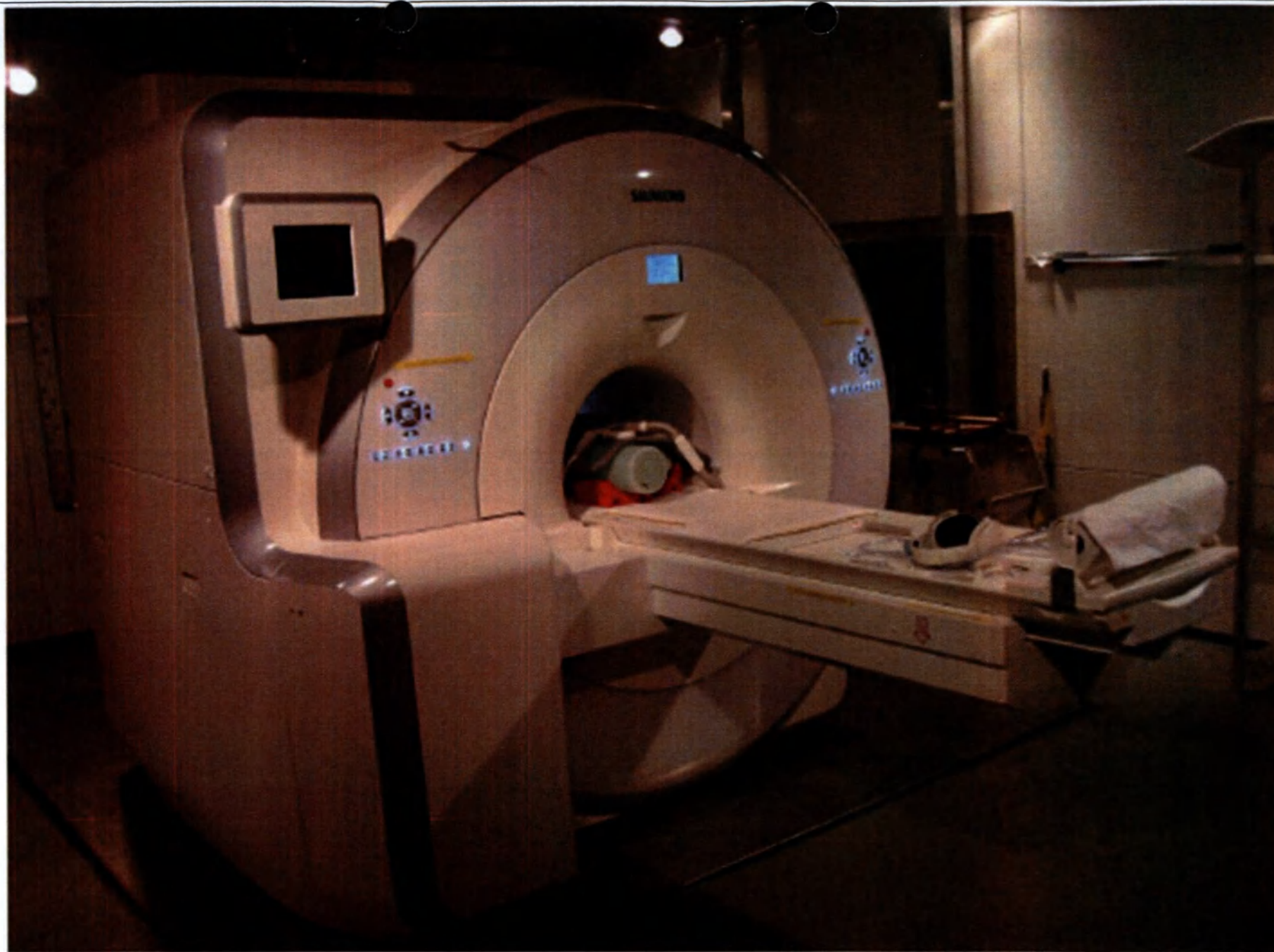
5. Кожух магнита с системой связи с пациентом, системой вентиляции и освещения в туннеле магнита.
