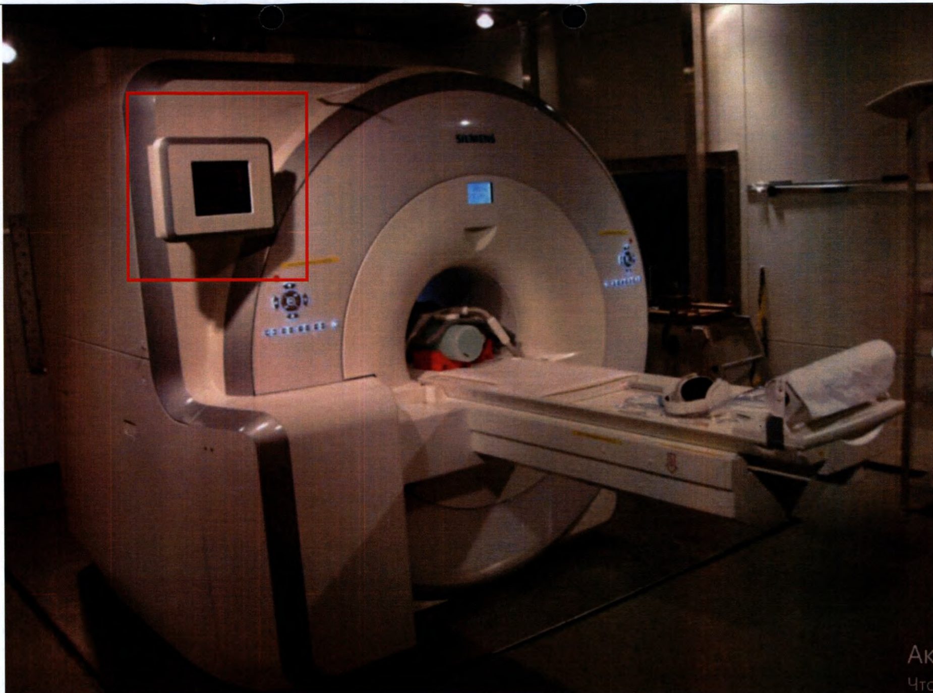
136. Дисплей на кожухе магнита для отображения физиологических параметров.
