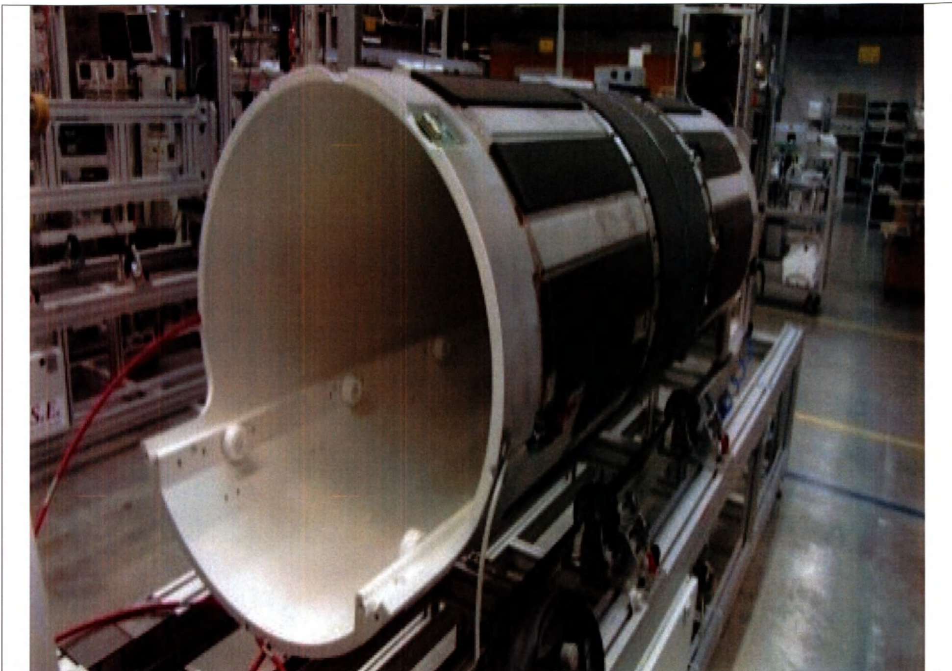
4. Катушка для тела, интегрированная в магнит.
