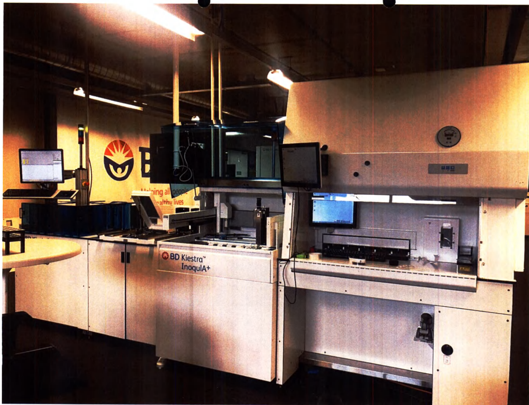
Рисунок 1. Автоматизированная бактериологическая рабочая станция для обработки образцов BD Kiestra Inoqua+, в составе: Модуль SorterA для сортировки чашек Петри; Модуль BarcodA для маркировки чашек Петри; Модуль FA для обработки образцов в автоматическом режиме; Модуль SA для обработки образцов в полуавтоматическом режиме.
