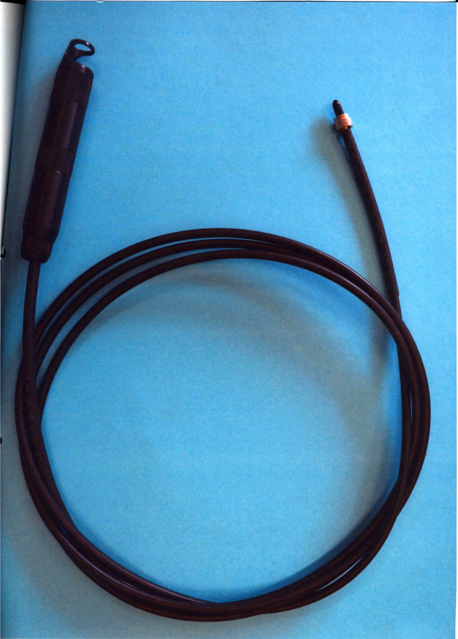
Световод с фокусирующей линзой
