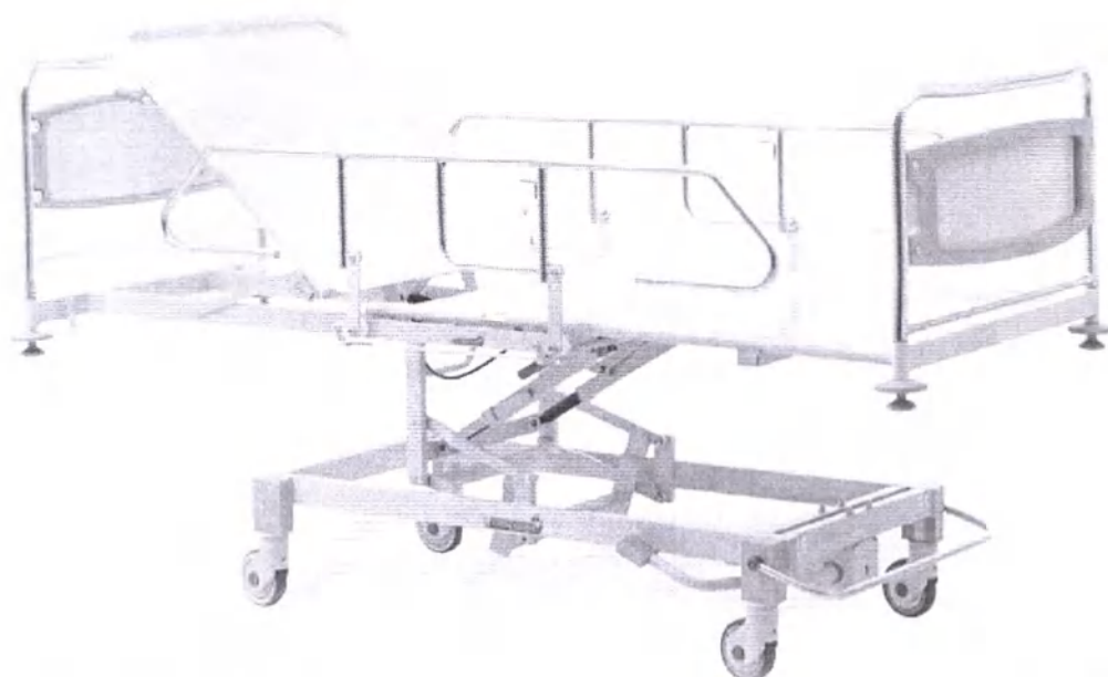
Кровать медицинская функциональная 2-х секционная с регулировкой спинной, положения тренделенбург/антитренделенбург с помощью блокируемых газовых пружин, регулировка высоты с помощью гидропривода, с регулировкой спинной секции с функцией авторегрессии.
