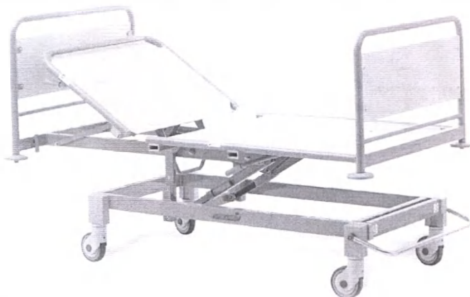
Кровать медицинская функциональная 2-х секционная с регулировкой спинной, ножной секций, положения тренделенбург/антитренделенбург с помощью блокируемых газовых пружин, фиксированная высота ложа кровати, с регулировкой спинной секции с функцией авторегрессии.
