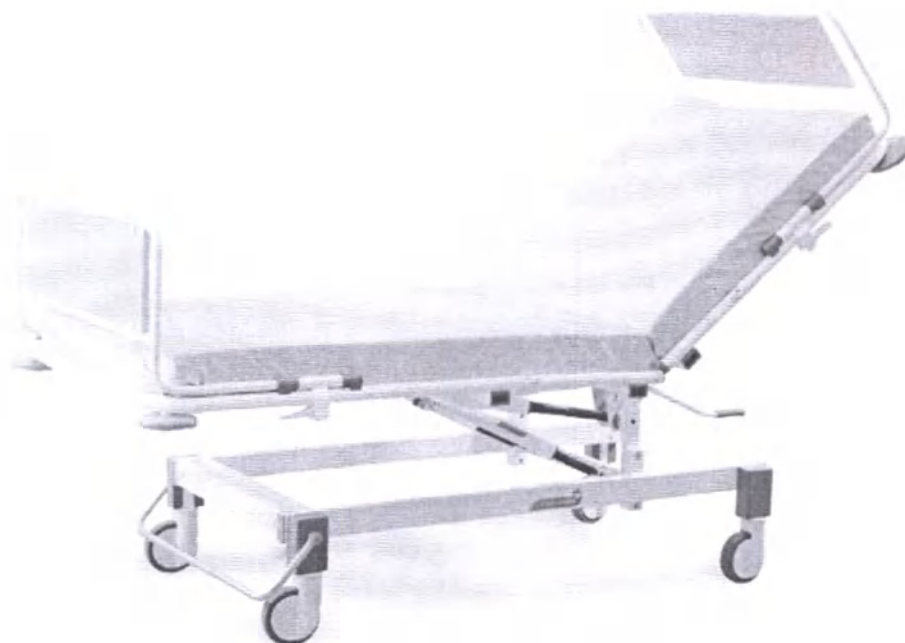
Кровать медицинская функциональная 2-х секционная с регулируемой пневматическими пружинами по углу наклона секцией головы, без регулировки высоты ложа
