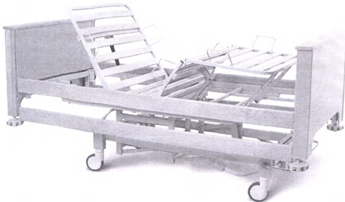
Кровать медицинская функциональная 4-х секционная гидравлическим приводами регулировки высоты ложа, спинной и тазобедренной секций и углов Тренделенбург (Анти-тренделенбург), дополнительный ручной наклон секции голени с помощью механизма «Rastomat».
