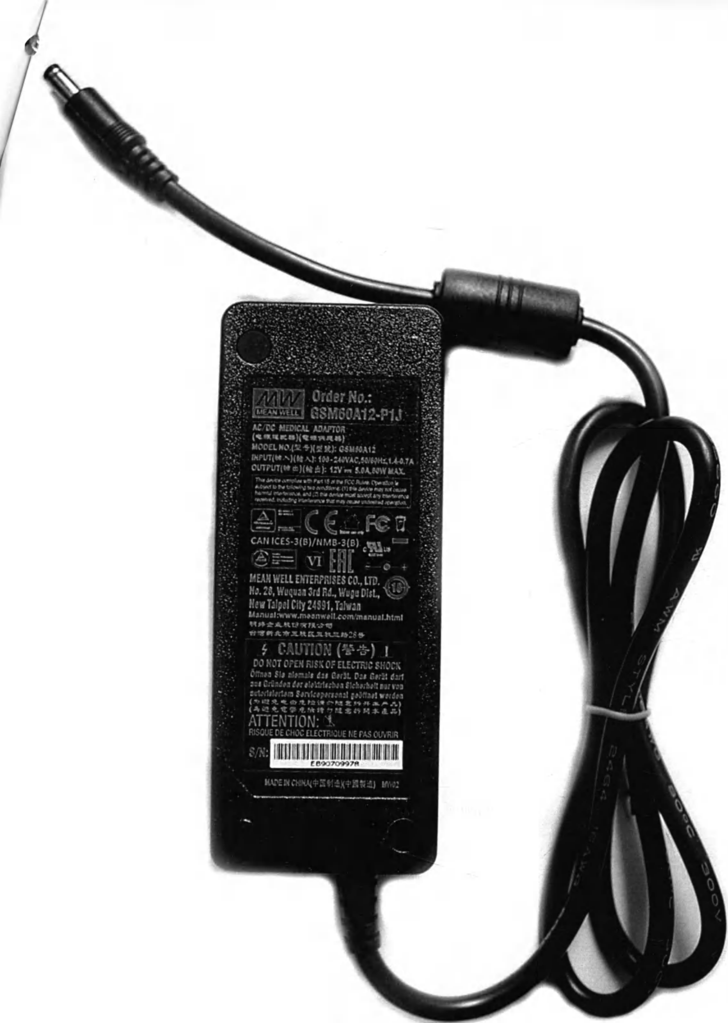
Преобразователь AC/DC 220/12В, 5А (вид нижней панели)
