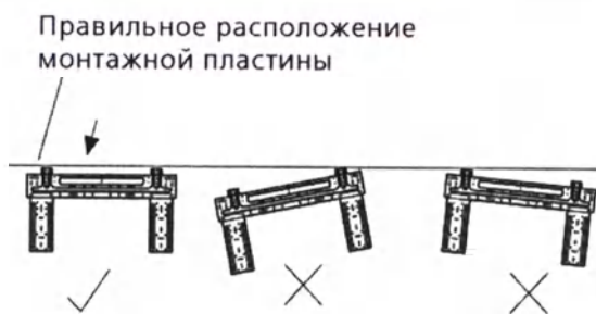
Рисунок 4 – Расположение монтажной пластины
