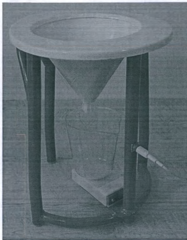
Рис. 13. Урофлоуметр УДС "АЛЬФА", отдельный канал с весовым измерителем SM-15, соединенный кабелем с измерительным блоком.
