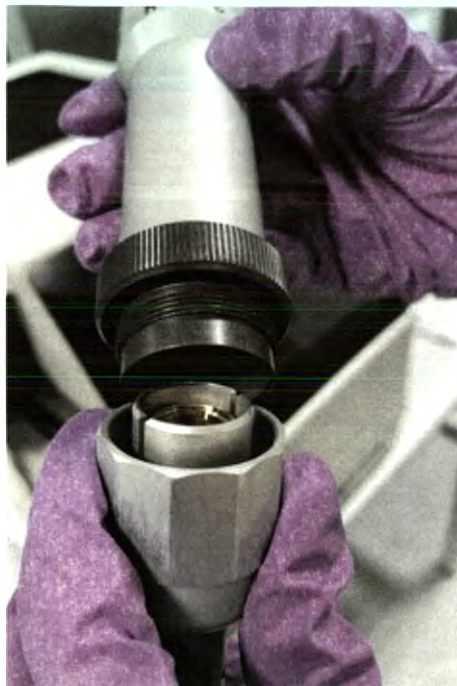
Рис. 8.10 – Подсоединение манипулы с перестраиваемым фокусом
