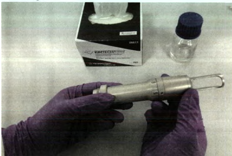
Рис.16.1 – Подготовка к очистке защитного окна манипулы с перестраиваемым фокусом
