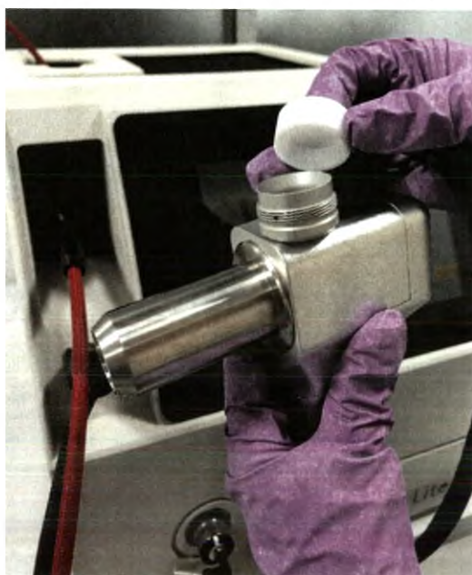
Рис.8.11 – Подсоединение волоконной системы вывода излучения к манипулятору 1064 нм
