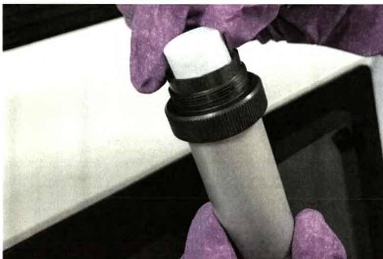
Рис. 8.9 – Подготовка к подсоединению манипулы с перестраиваемым фокусом.
