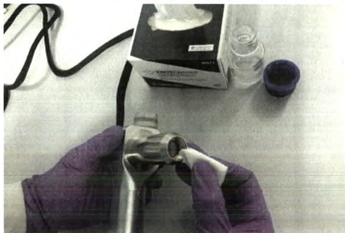
Рис.16.5 – Очистка защитного окна манипулятора 1064 нм
