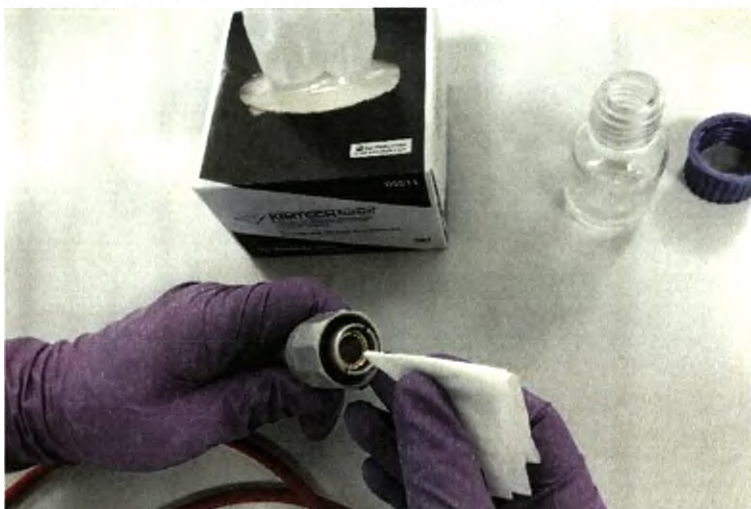
Рис.16.4 – Очистка торца волоконной системы вывода излучения
