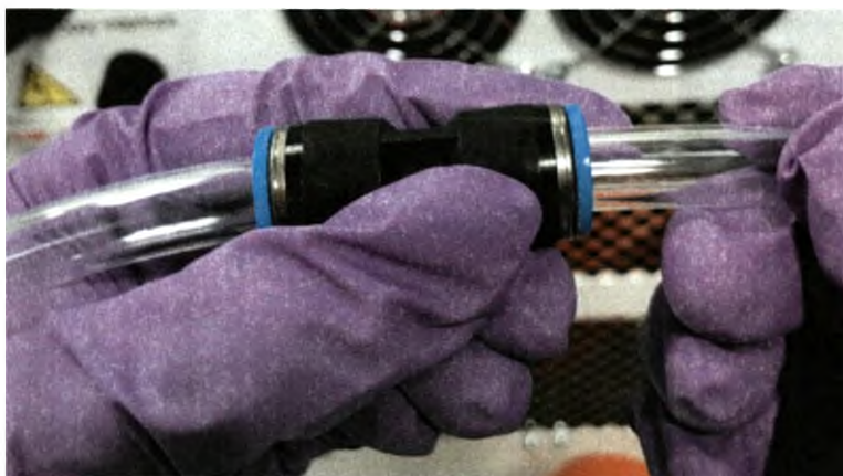
Рис.15.2 – Разборка шланга воронки
