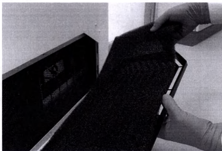
Рис.17.5 – Извлечение воздушного фильтра
