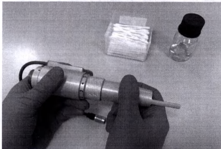
Рис.17.1 – Подготовка к очистке защитного окна
