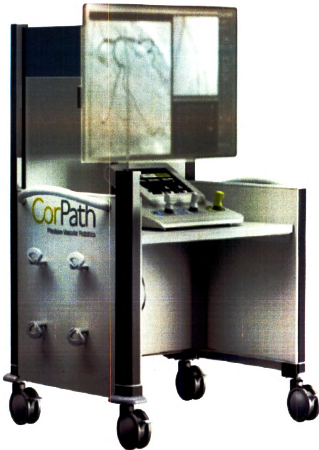
8. Мобильная кабина управления для размещения консоли управления и широкоформатного монитора.
