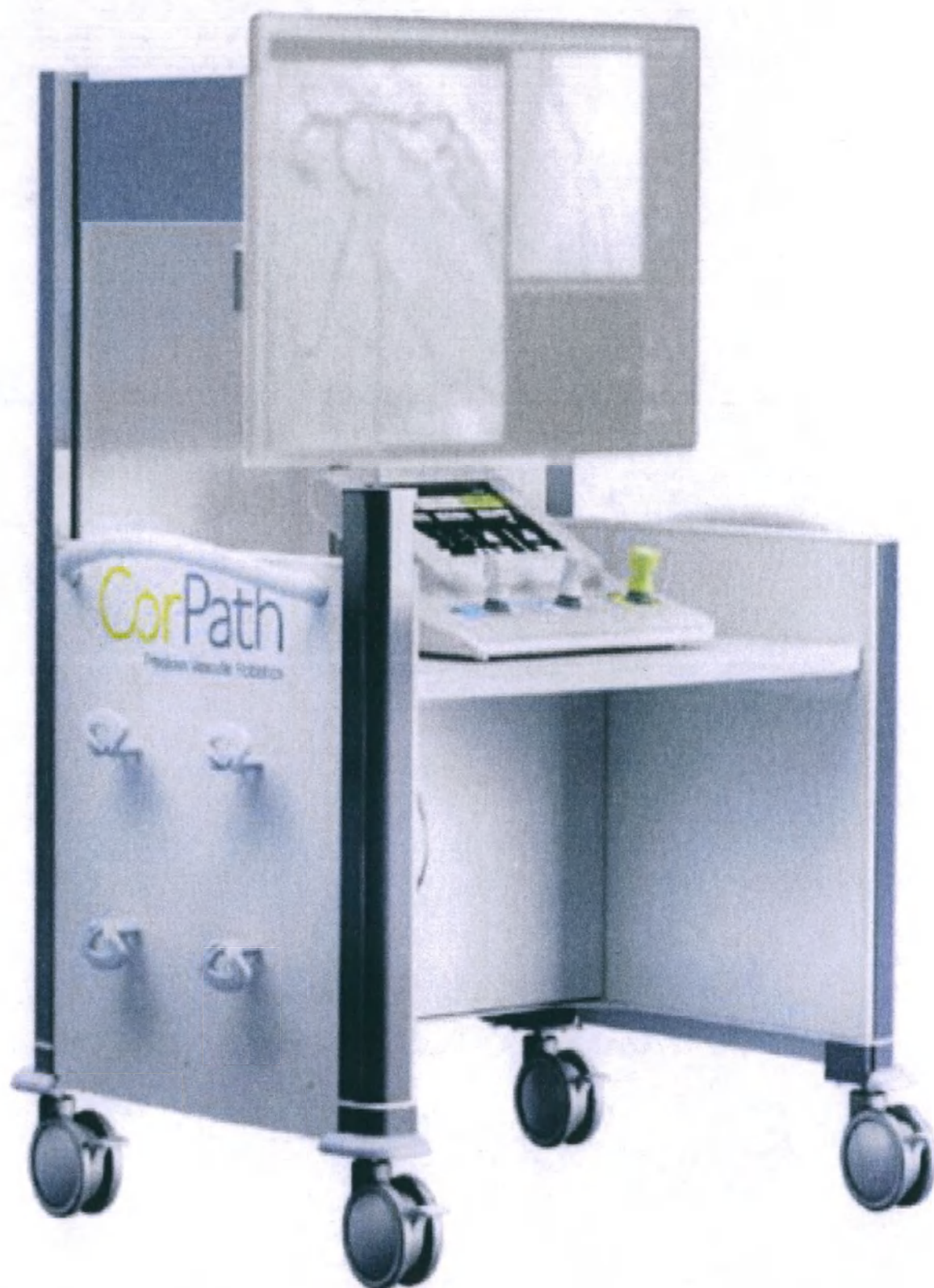
4. Мобильная кабина управления для размещения консоли управления и широкоформатного монитора.
