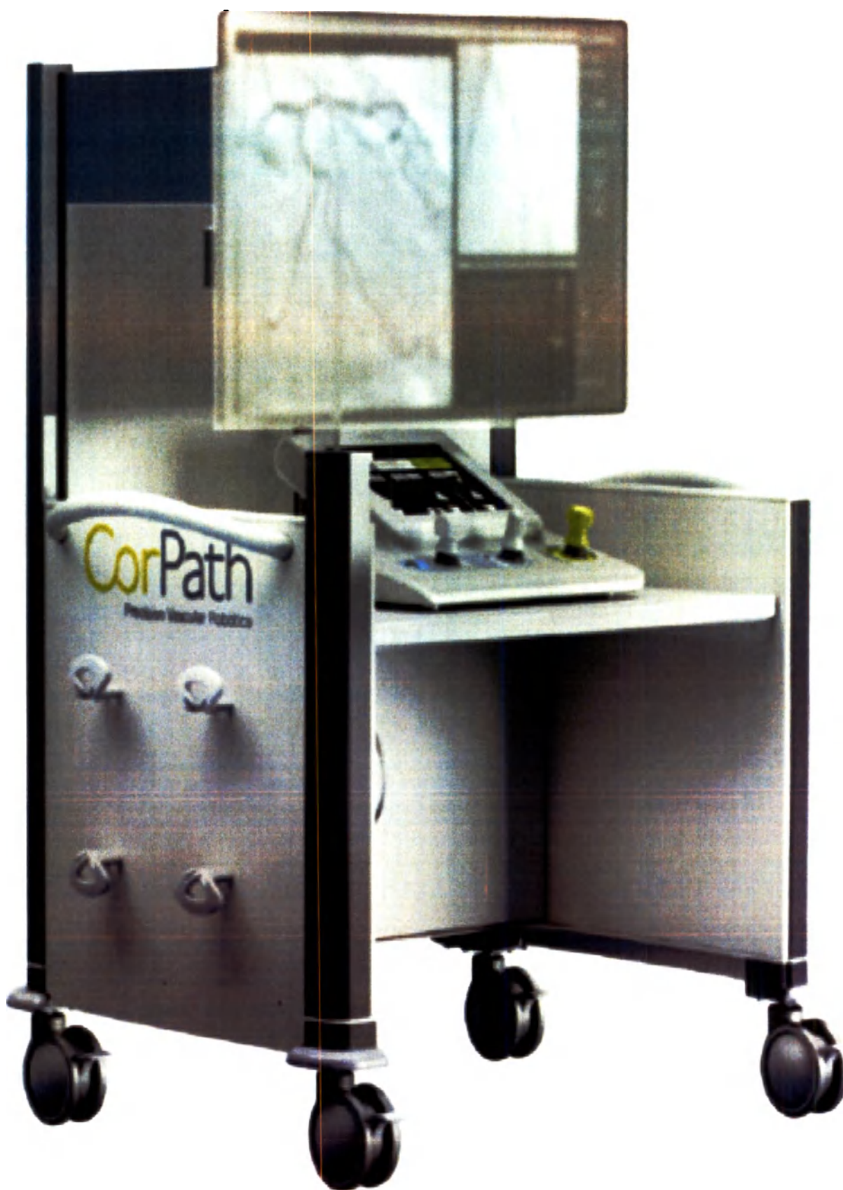
6. Мобильная кабина управления для размещения консоли управления и широкоформатного монитора.
