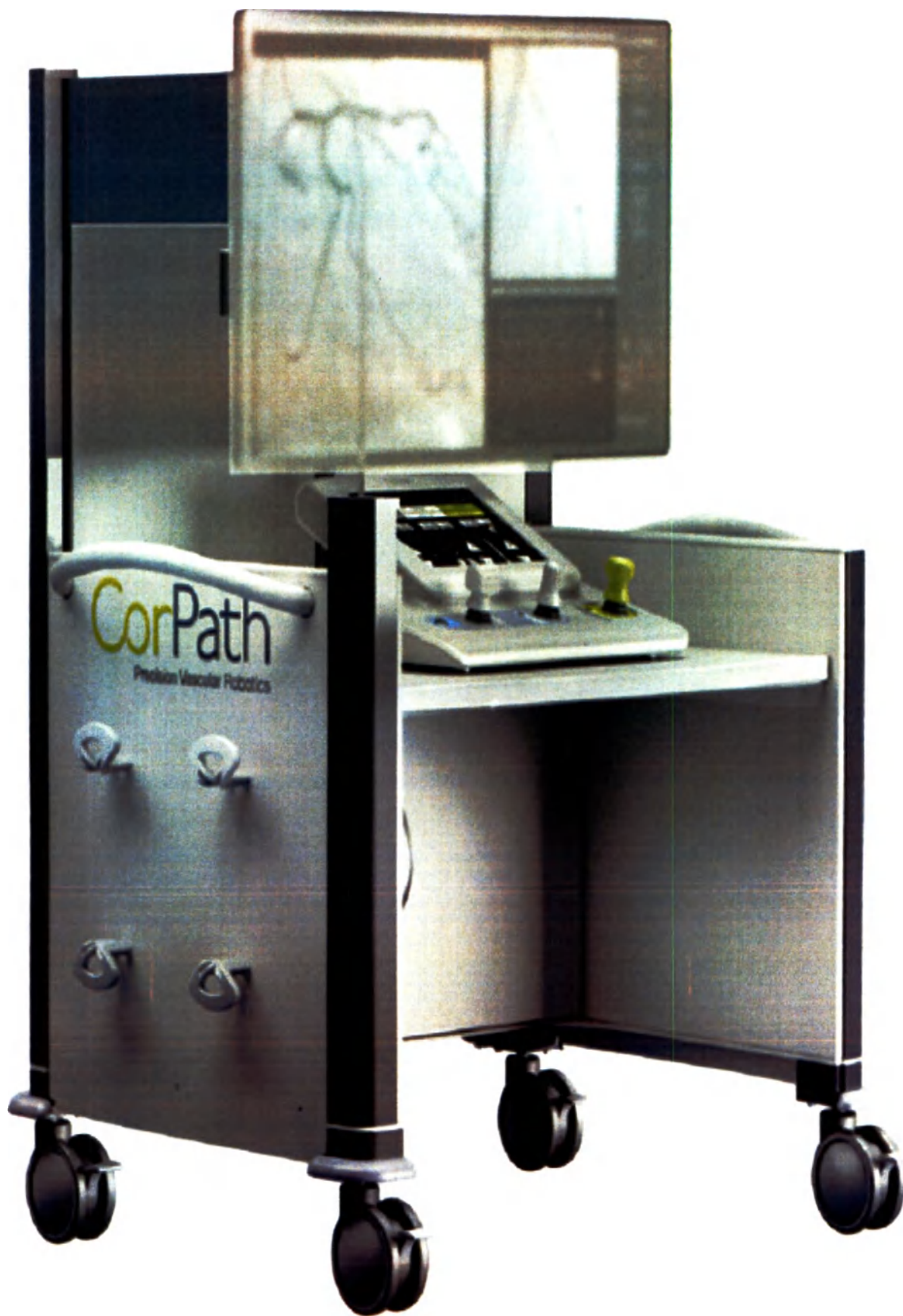
5. Мобильная кабина управления для размещения консоли управления, стандартных или среднеформатных мониторов.
