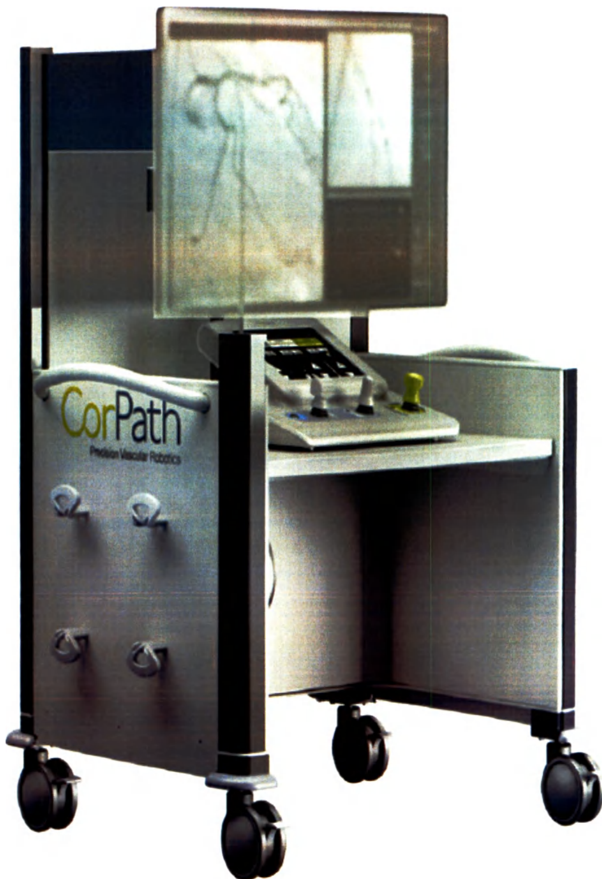
7. Мобильная кабина управления для размещения консоли управления, стандартных или среднеформатных мониторов.
