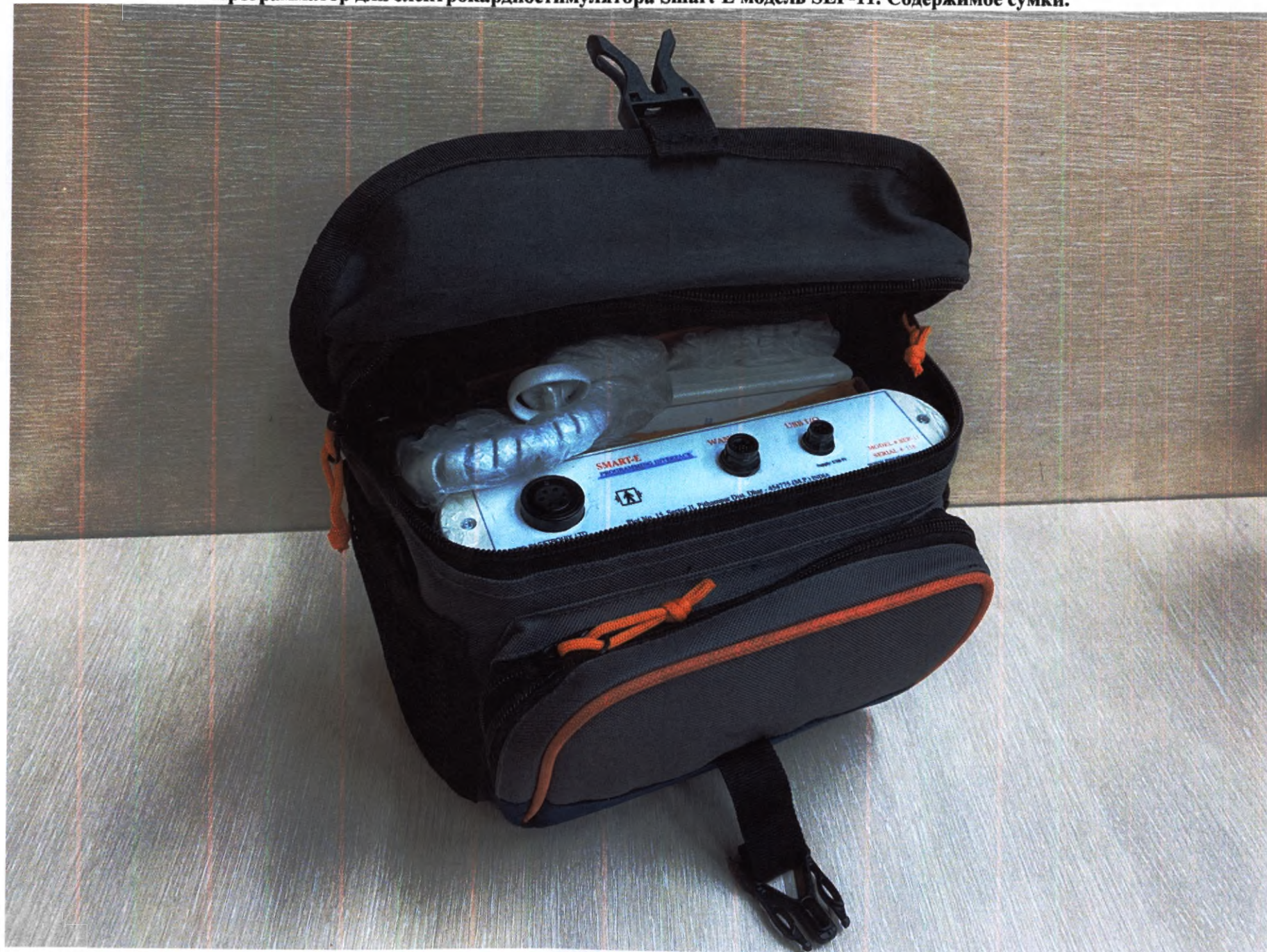
Программатор для электрокардиостимулятора Smart-E модель SEP-11. Содержимое сумки.
