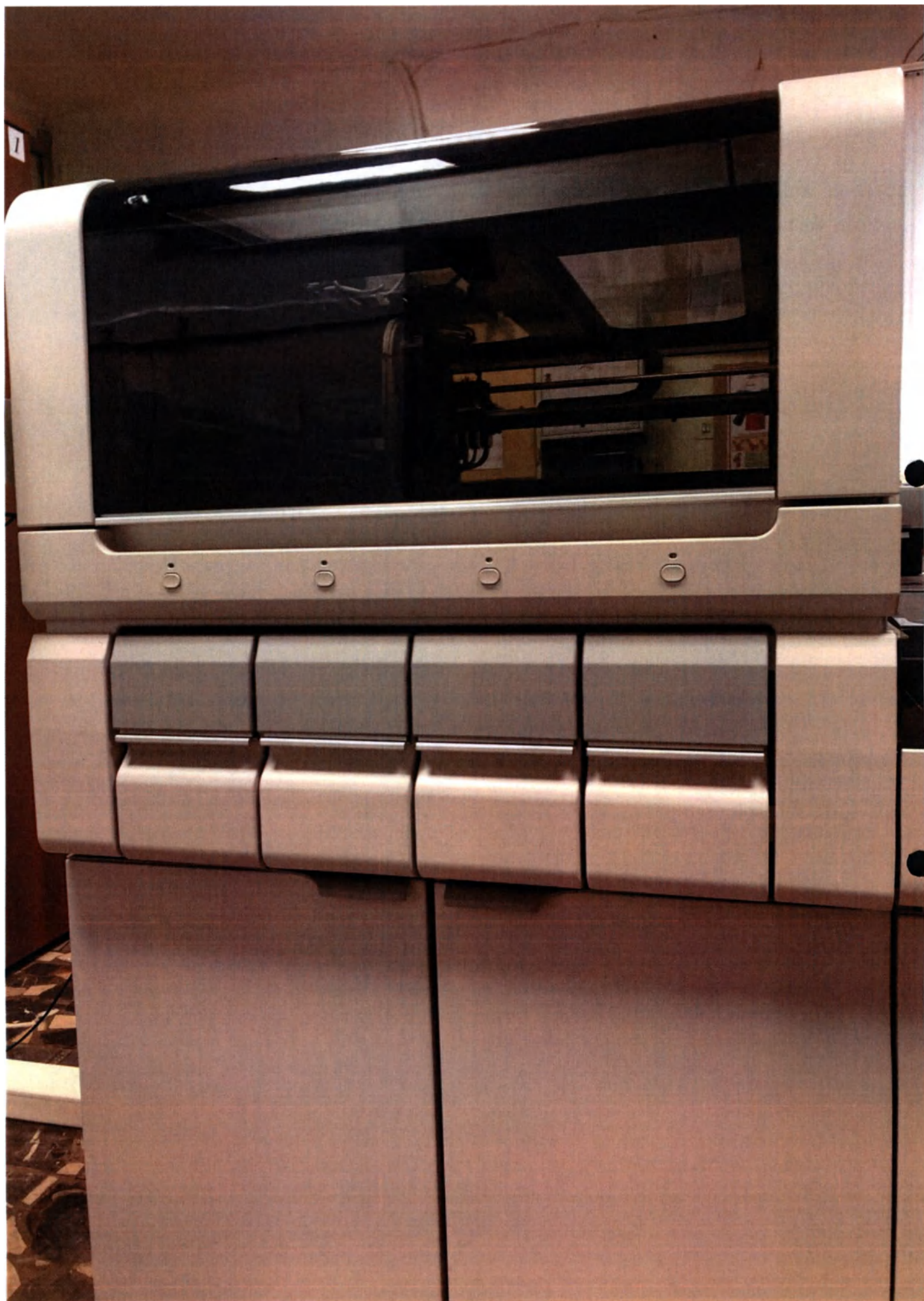
1. Блок системы сортировки и транспортировки пробирок с образцами Atellica SH Additional
